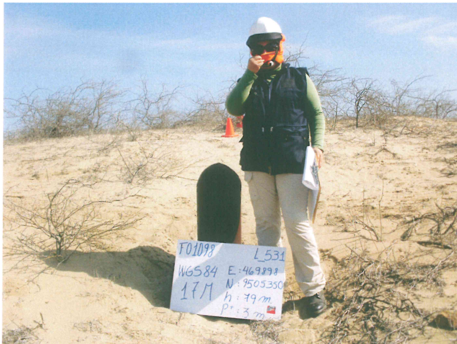
Fotografía N° 1. Pozo L_531 con cubierta metálica y de punta Convexa
