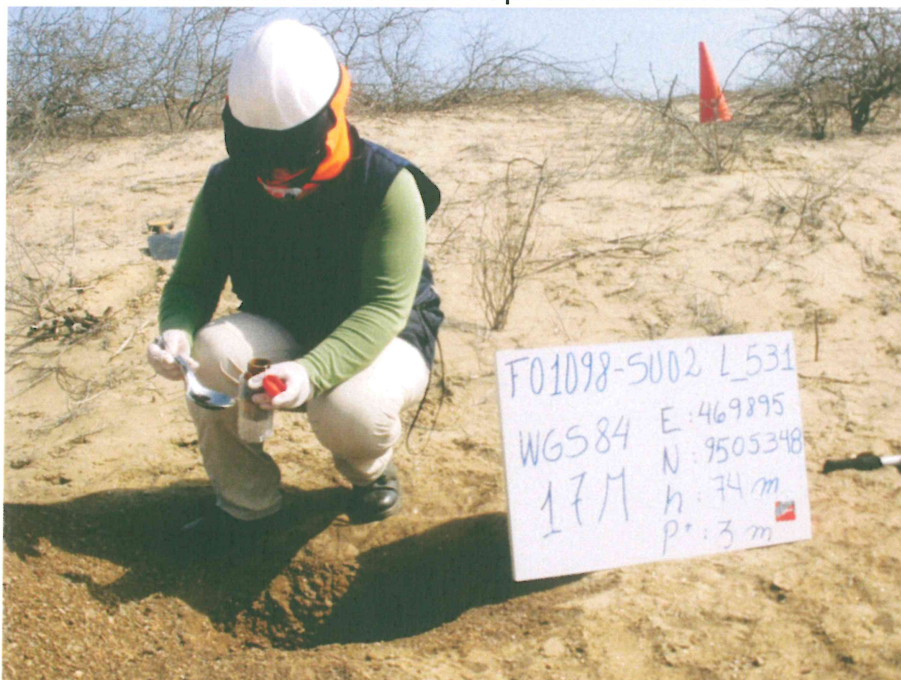
Fotografía N° 4. Toma de muestra de suelo en el punto F01098-SU02 ubicado a 4.0 m aproximadamente del Pozo L_531 si se observa suelos impregnados.
