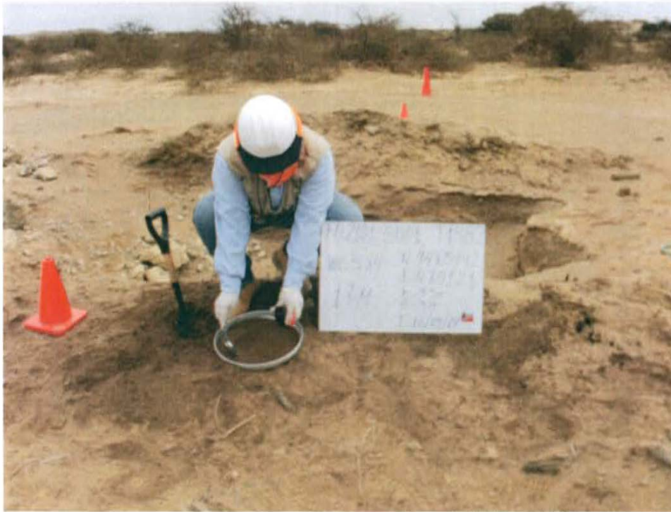
Fotografía N° 3. Toma de muestra de suelo en el punto F02101-SU01, ubicado a 2 m aproximadamente del Pozo T1582.
