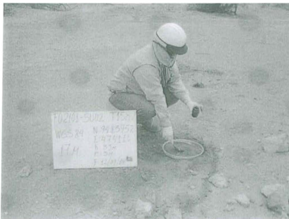
Fotografía N° 2. Toma de muestra de suelo en el punto F02101-SUO2, ubicado a 6 m aproximadamente del Pozo T1582.
