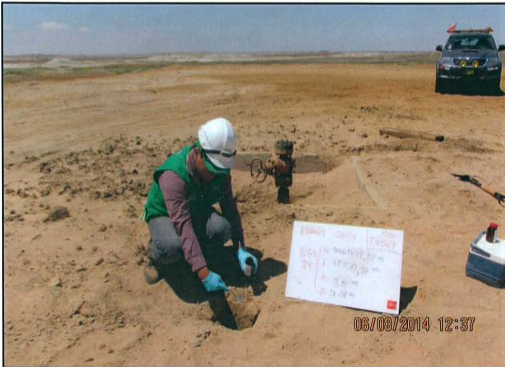
Fotografía N° 3. La muestra de suelo F01664-SU01 se tomó a 2,5 m de distancia del Pozo y a una profundidad de 0,35 m de la superficie del suelo.
