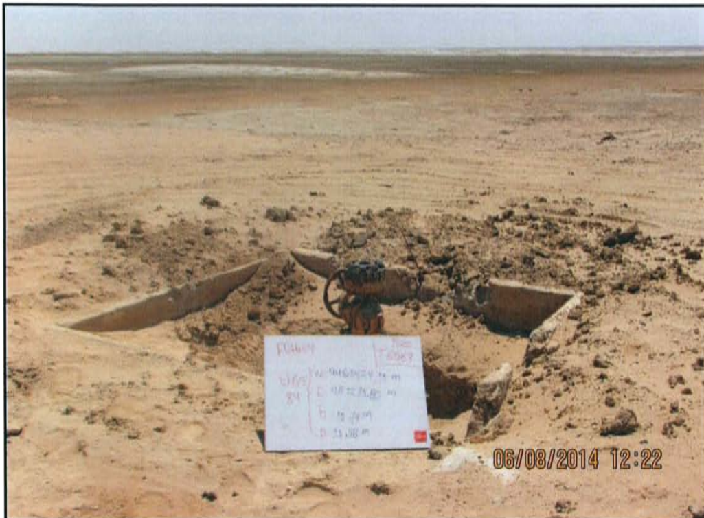
Fotografía N° 4. La muestra de suelo F01664-SU02 se tomó a 2,2 m de distancia del Pozo y a una profundidad de 0,38 m de la superficie del suelo.
