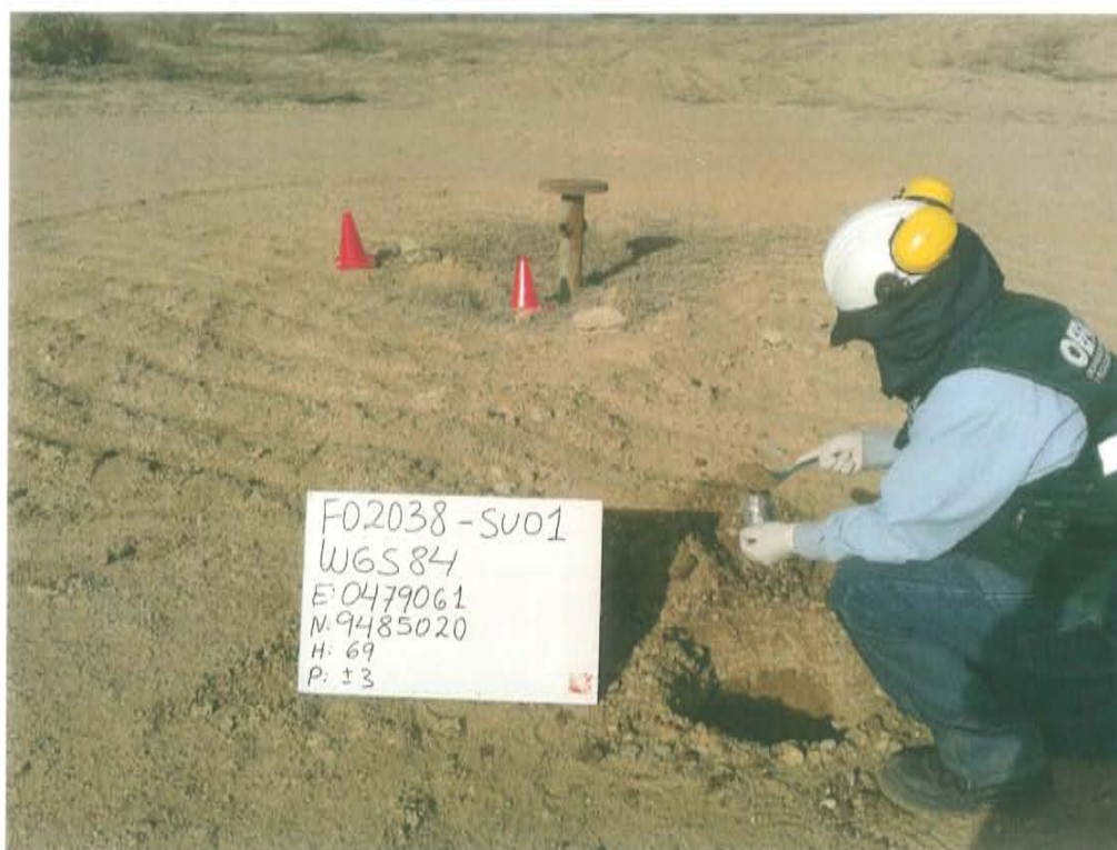
Fotografía N° 3. Toma de muestra de suelo en el punto F02038-SU01, ubicado a 3 m aproximadamente del Pozo T3086.
