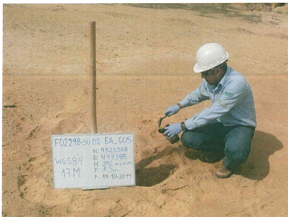
Fotografía N° 4. Toma de muestra de suelo en el punto F02298 -SU02, ubicado a 4 m del Pozo A_605.
