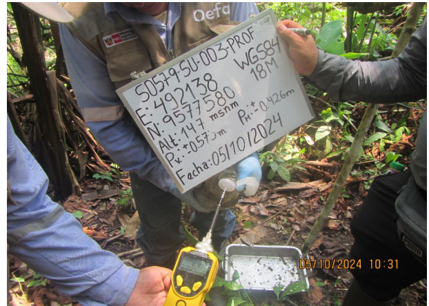
Toma de medición de compuestos orgánicos volátiles (COV) sobre muestra con código
