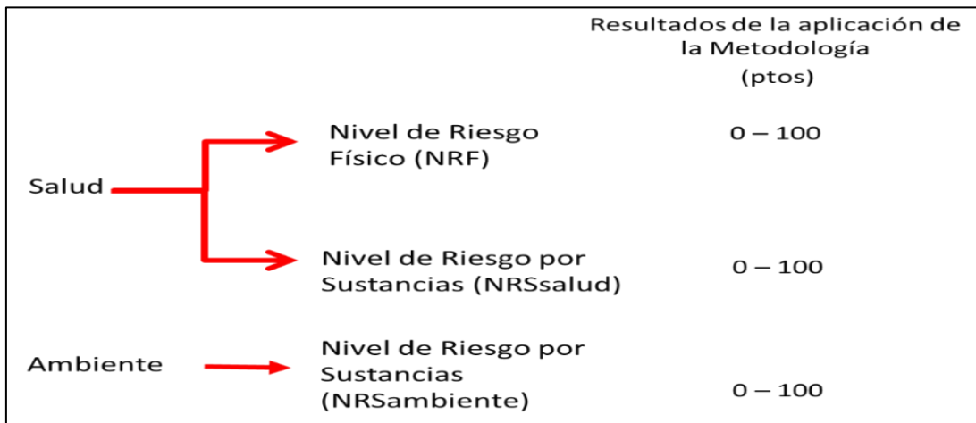
Figura 7.2. Indicadores de riesgos por presencia de peligros de tipo físico y por presencia de sustancias contaminantes
