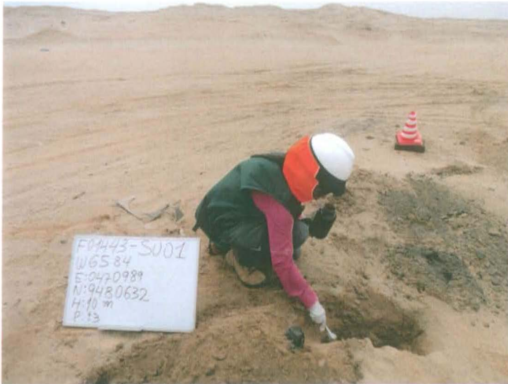
Fotografía N° 3. Toma de muestra de suelo en el punto F01443-SU01 a 1 m de distancia del pozo evaluado.
