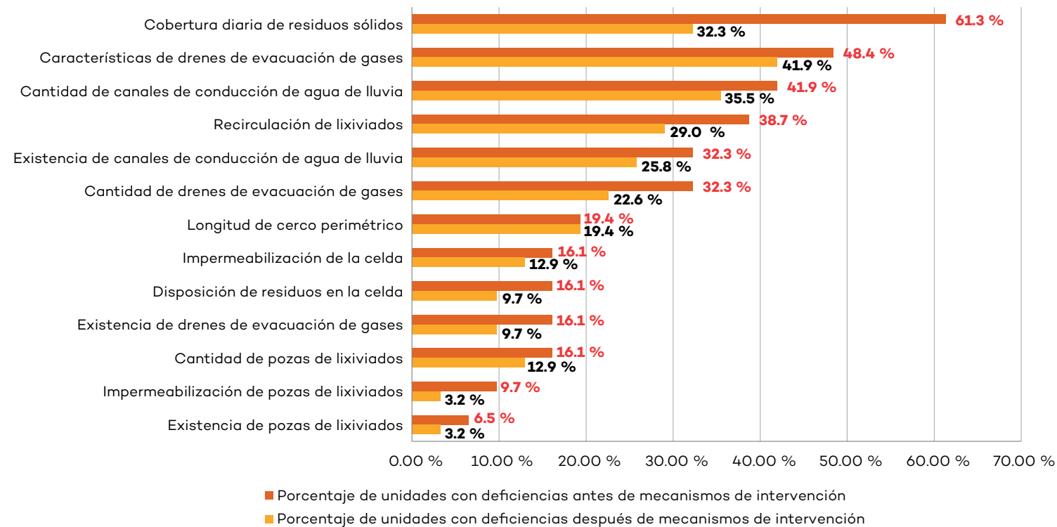
Figura 64. Principales deficiencias identificadas en IDF antes y después de los mecanismos de intervención
