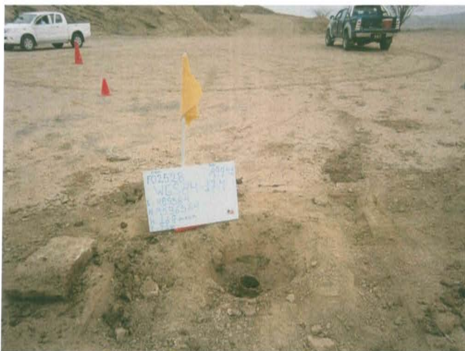
Fotografía N° 2. Se observa que el pozo inactivo abierto, sin elemento de cierre en superficie como válvulas, llaves entre otros, no garantizando el cierre hermético del pozo.
