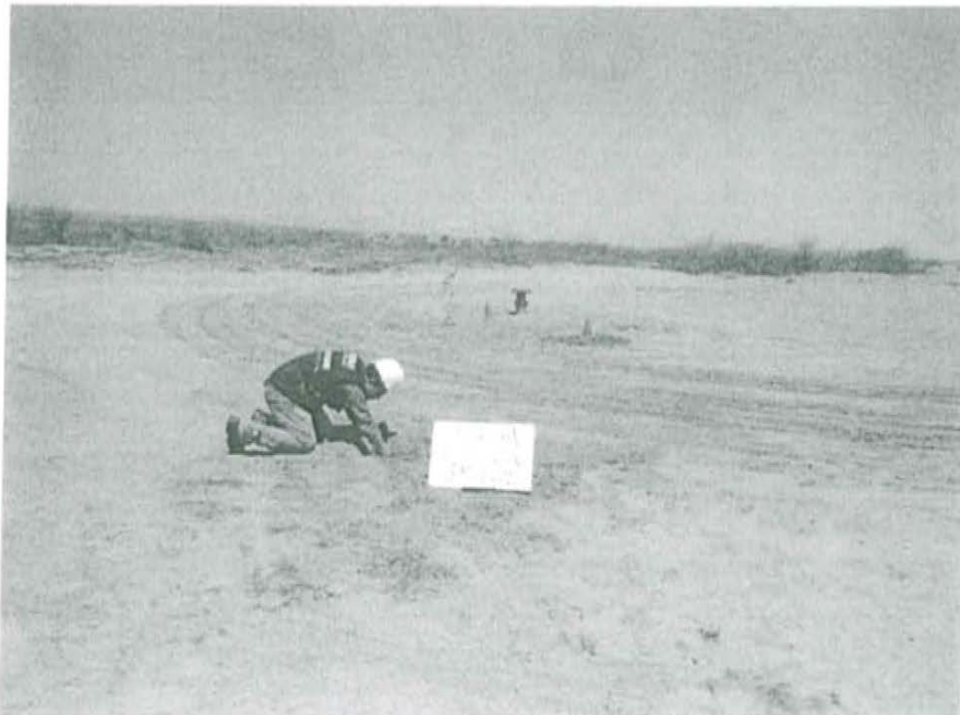
Fotografía N° 2. Toma de muestra de suelo en el punto F02061-SU02, ubicado al Noroeste del pozo y a 7,0 m aproximadamente del Pozo T2676
