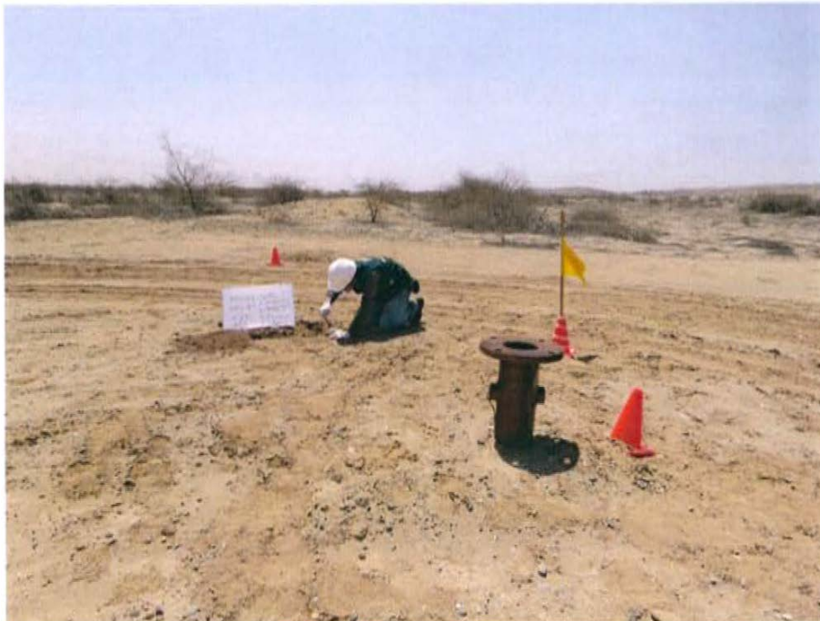
Fotografía N° 3. Toma de muestra de suelo en el punto F02061-SU01, ubicado a Noroeste del pozo y a 2,5 m aproximadamente del Pozo T2676.
