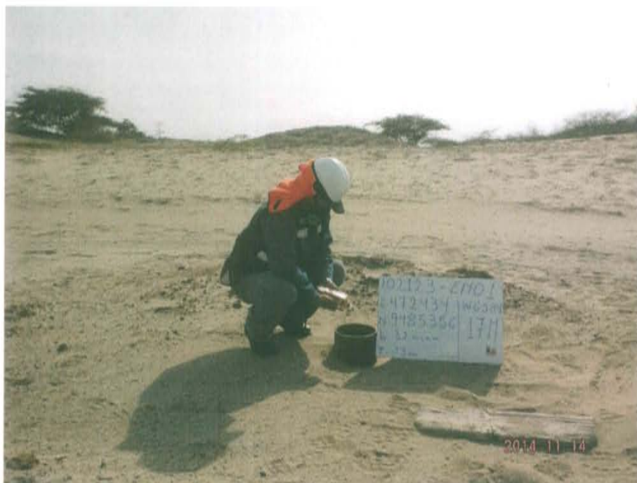
Fotografía N° 5. Vista del monitoreo de emisiones gaseosas fugitivas a boca del pozo F02123-EM01
