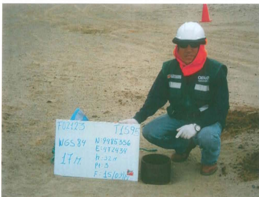
Fotografía N° 1. Vista de ubicación del pozo donde se observa el pozo con el tubo de revestimiento en estado de deterioro y abierto al ambiente.
