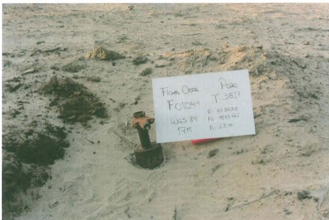
Fotografía N° 1. Identificación del pozo inactivo con código PERUPETRO T3817. Presenta casing con tubería de reducción y válvulas deterioradas que no asegurarían el hermetismo del pozo.
