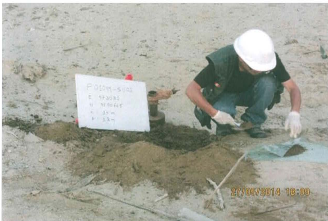
Fotografía N° 3. Toma de muestra de suelo en el punto F01044-SU01, ubicado a 1,4 m aproximadamente del Pozo T3817.
