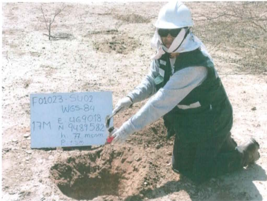
Fotografía N° 4. Toma de muestra de suelo F01023-SU02 a 28 m del Pozo T1874 y a una profundidad de 0,40 m de la superficie del suelo.
