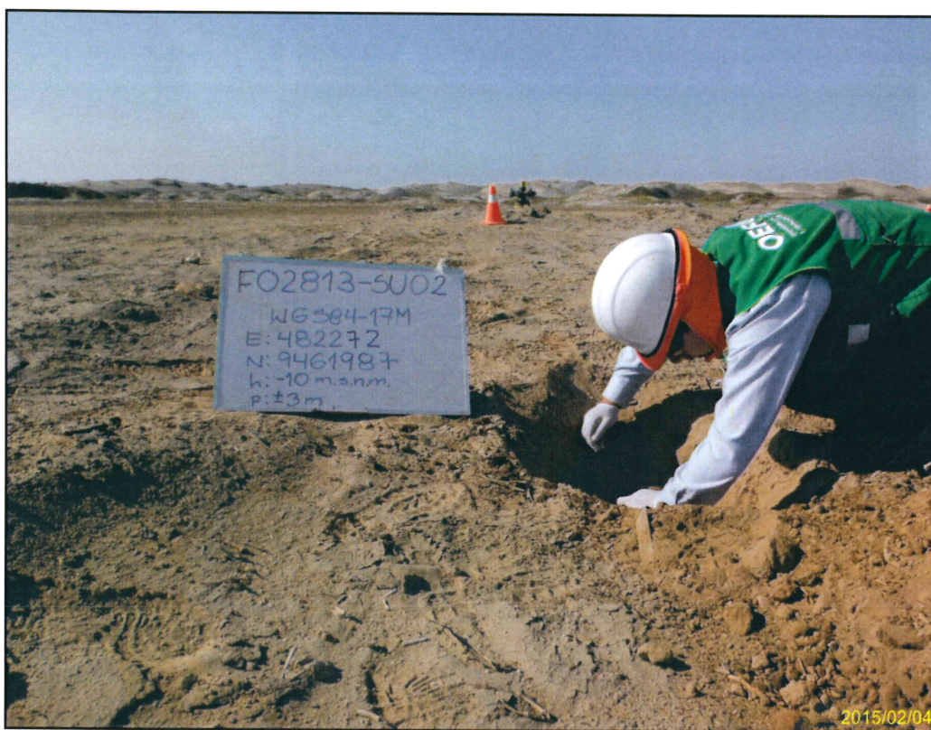
Fotografía N° 3. Toma de muestra de suelo en el punto F02813-SU02, ubicado a aproximadamente 7 m del Pozo T5920.
