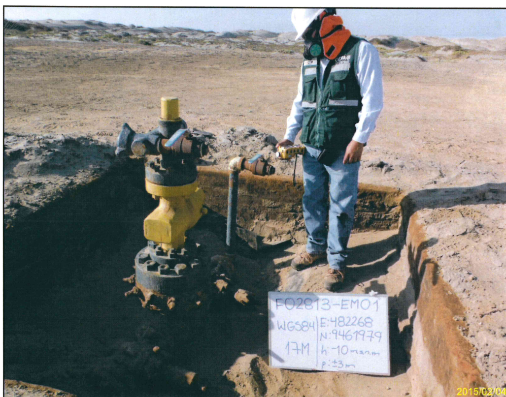
Fotografía N° 4. Medición de emisiones fugitivas en boca de Pozo T5920.
