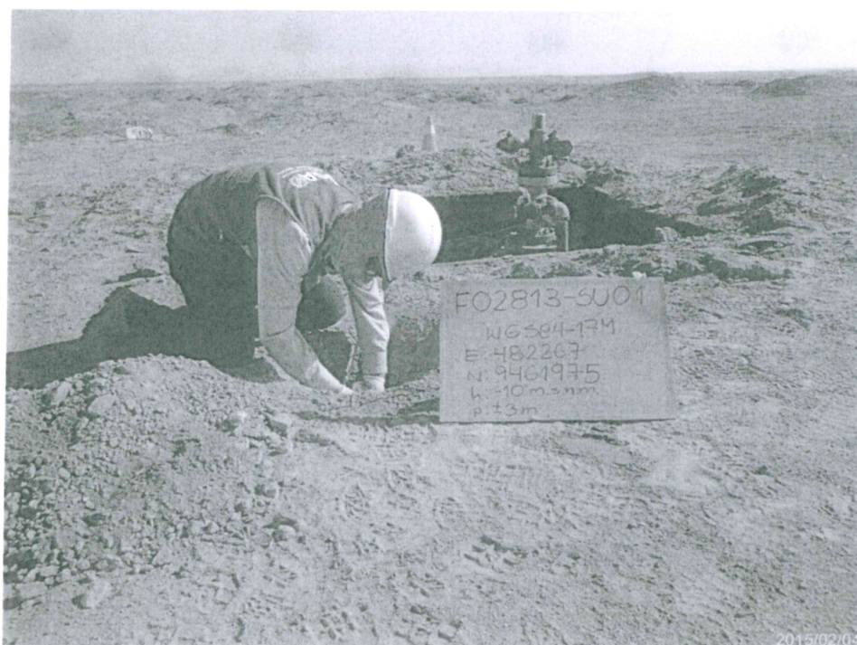
Fotografía N° 1. Toma de muestra de suelo en el punto F02813-SU01, ubicado a 2 m aproximadamente del Pozo T5920.
