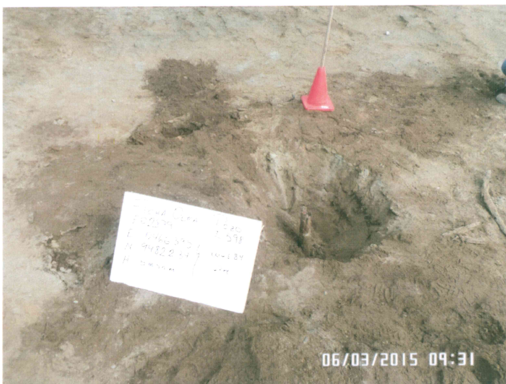
Fotografía N° 1. Vista pozo T_598, se observa el tubo abierto al ambiente y rodeado de suelo contaminado por hidrocarburos.
