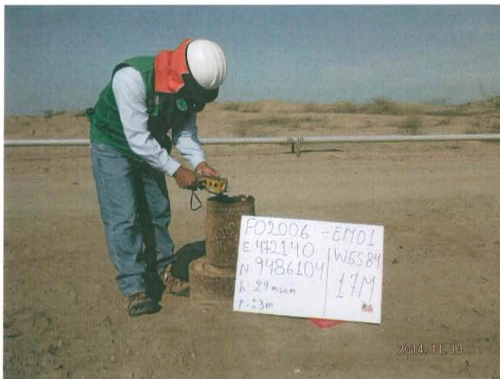
Fotografía N° 4. Medición en el punto F02006-EM01, ubicado en la boca del Pozo.
