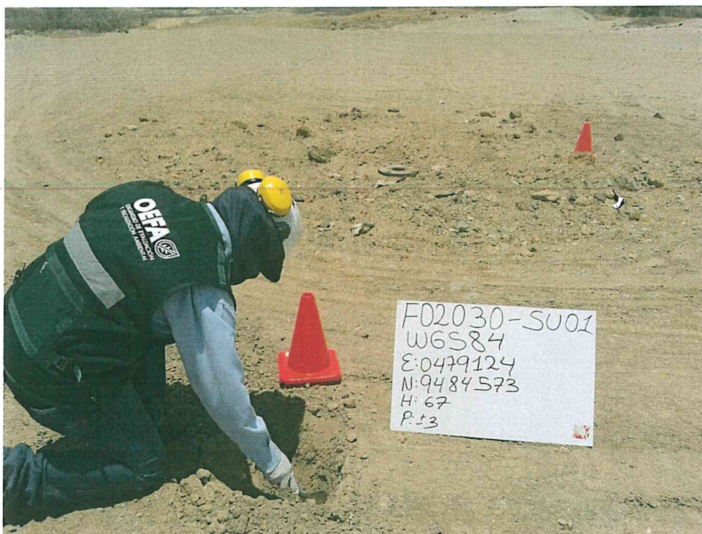
Fotografía N° 3. Toma de muestra de suelo en el punto F02030-SU01, ubicado a 4 m aproximadamente del Pozo T3157.
