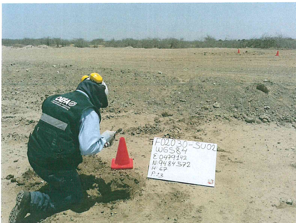
Fotografía N° 4. Toma de muestra de suelo en el punto F02030-SU02, ubicado a 11 m aproximadamente del Pozo T3157.
