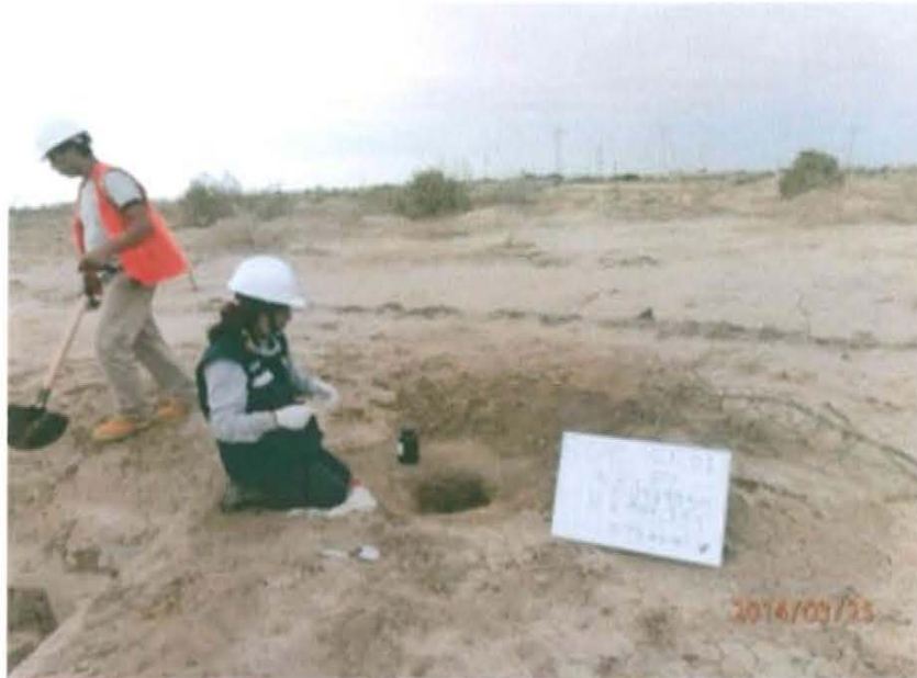
Fotografía N° 3. Punto de muestreo de suelo F00791-SU01 a 0,80 m del casing y a una profundidad de 0,45 m de la superficie del suelo.
