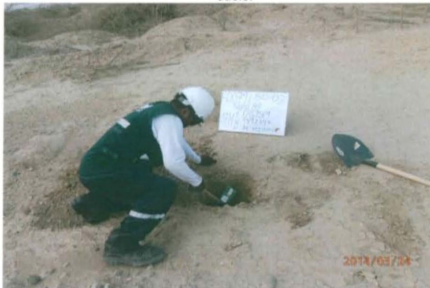
Fotografía N° 4. Punto de muestreo de suelo F00791-SU02 a 18 m del casing y a una profundidad de 0,45 m de la superficie del suelo.
