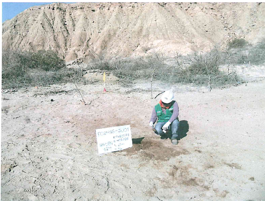
Fotografía N° 3. Toma de muestra de suelo en el punto F02416-SU01, ubicado a 7,6 m de la posible ubicación del casing del pozo
