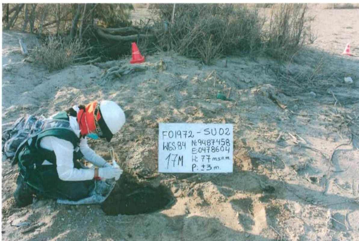
Fotografía N° 04. Toma de muestra de suelo en el punto F01972-SU02, ubicado a 4,35 m aproximadamente del Pozo T3087.
