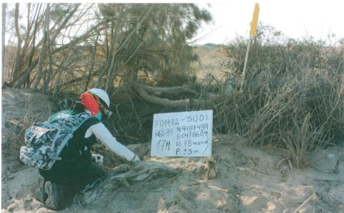
Fotografía N° 03. Toma de muestra de suelo en el punto F01972-SU01, ubicado a 1,35 m aproximadamente del Pozo T3087.
