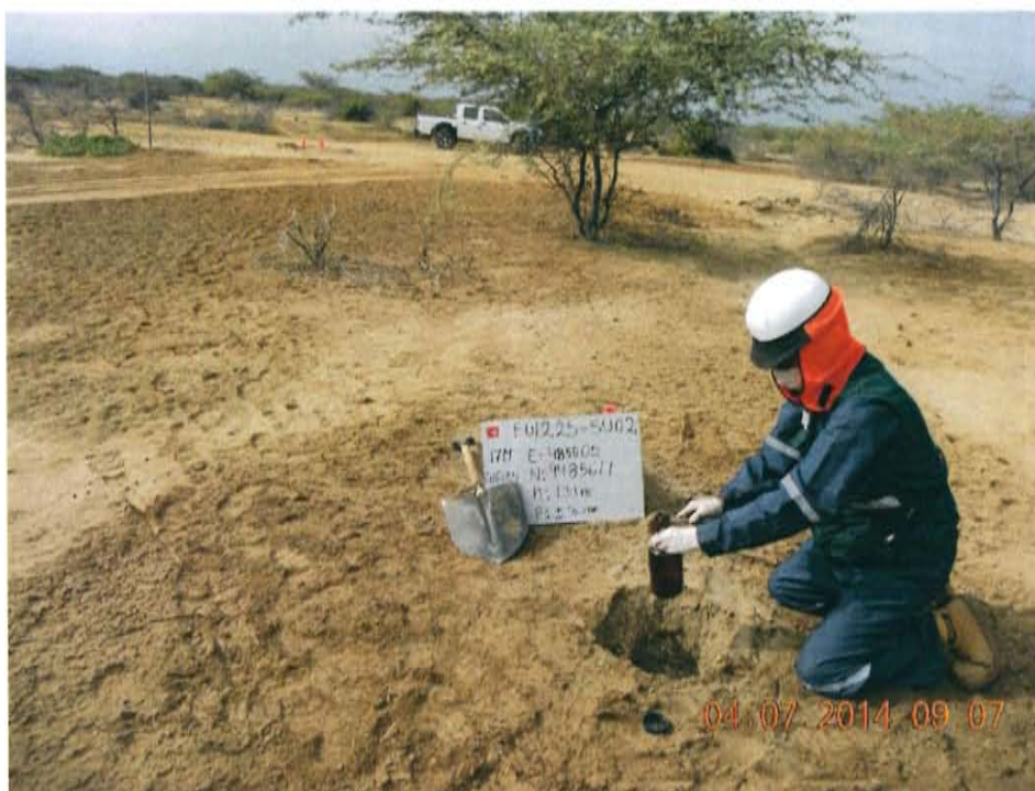
Fotografía N° 3. Muestreo de suelo en el punto F01225-SU02.
