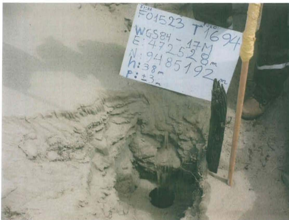
Fotografía N° 1. Identificación del pozo inactivo con código PERUPETRO T1694. Presenta casing abierto al medio ambiente.
