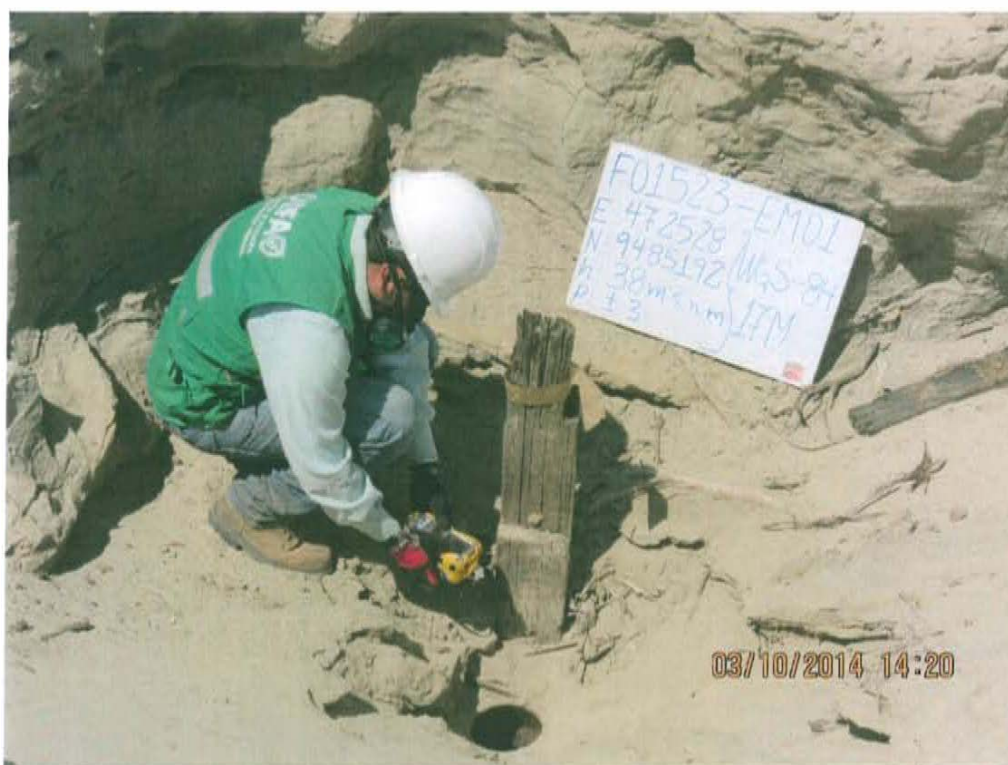
Fotografía N° 4. Medición en el punto F01523-EM01, ubicado en la fuente de emisión en boca del Pozo T1694.
