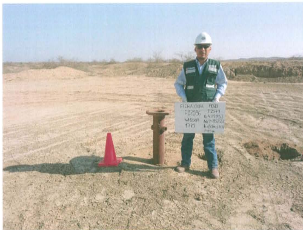
Fotografía N° 1. Identificación del pozo inactivo con código PERUPETRO T2574. Presenta casing con tapa de brida adaptadora con tuberías de salida lateral, expuestas a la intemperie.
