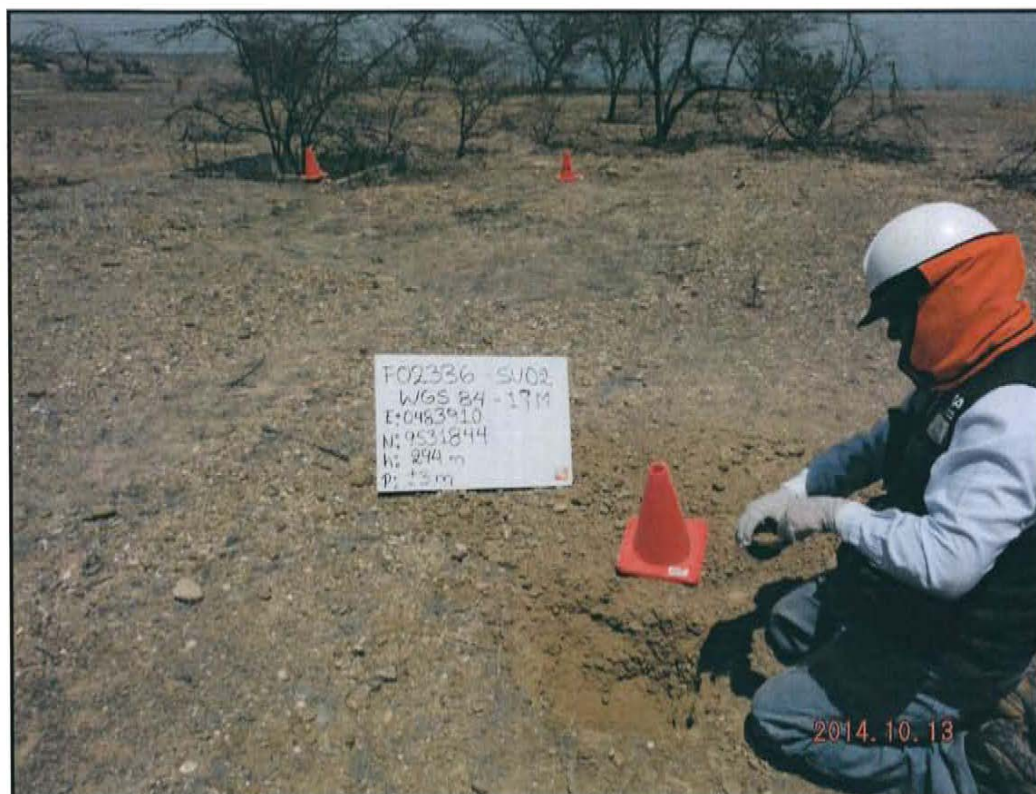
Fotografía N° 4. Toma de muestra de suelo en el punto F02336-SU02, ubicado a 6 m del Pozo A2381.
