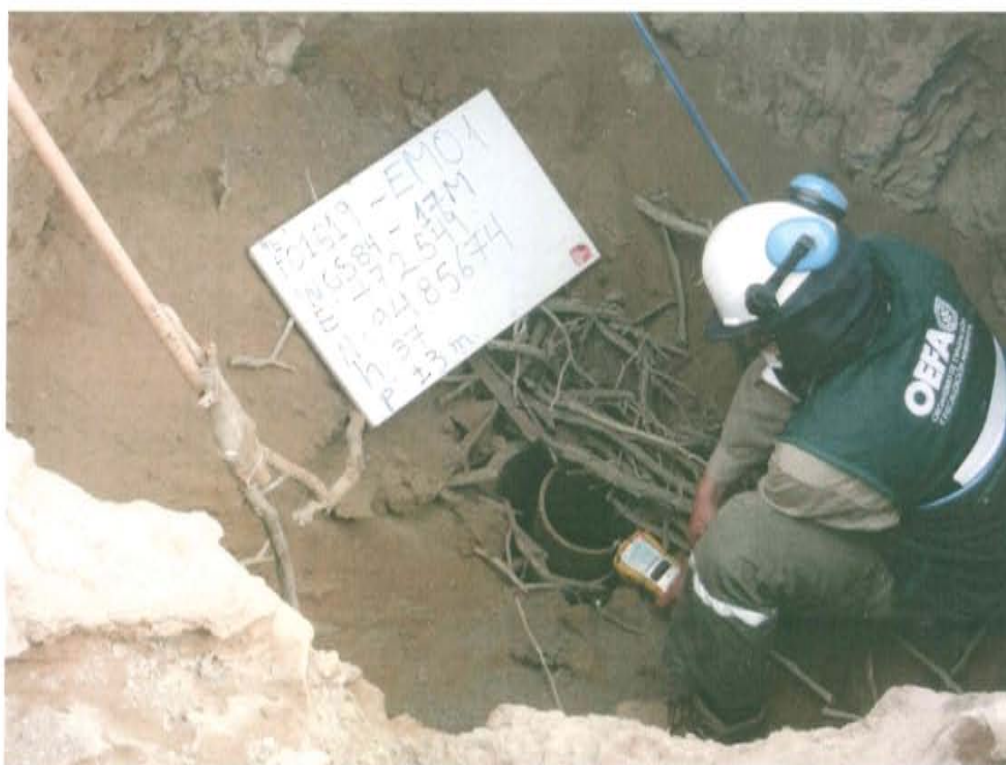
Fotografía N° 4. Medición en el punto F01519-EM01, ubicado en la fuente de emisión en boca del Pozo T1430.
