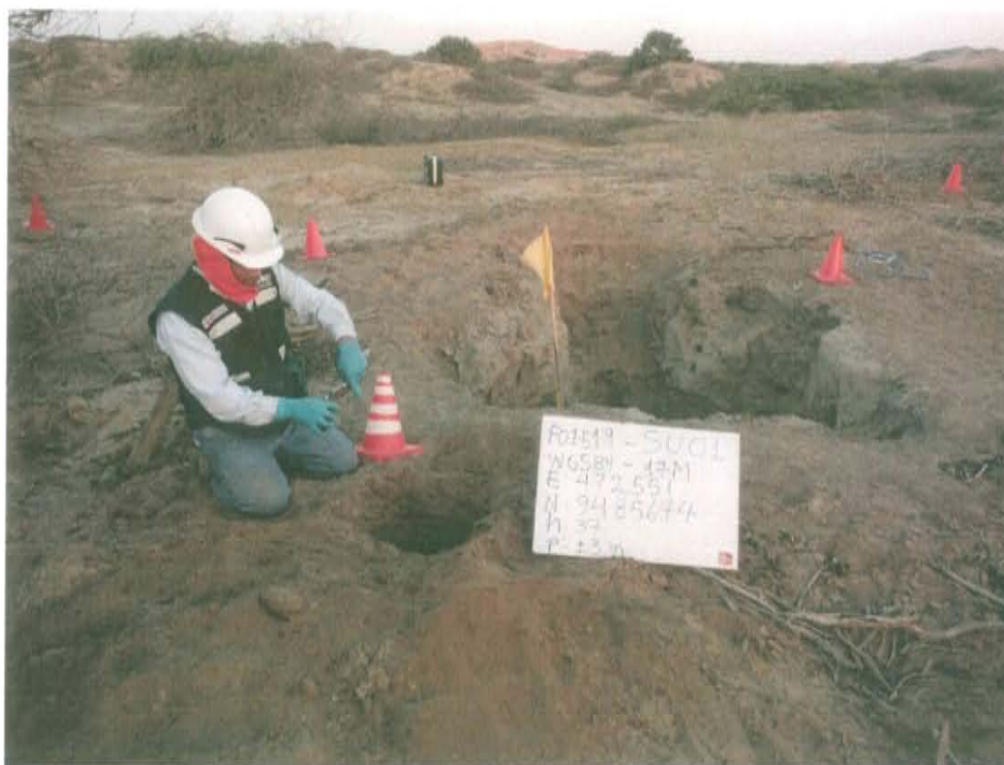
Fotografía N° 3. Toma de muestra de suelo en el punto F01519-SU01, ubicado aproximadamente a 3 m al norte del Pozo T1430.
