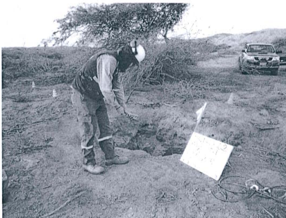
Fotografía N° 2. Mediciones en el F01519-VA01, se realizó en un recorrido en el área circundante alrededor del pozo T1430 en un radio de 1 a 3 m, con una duración de 10 minutos.
