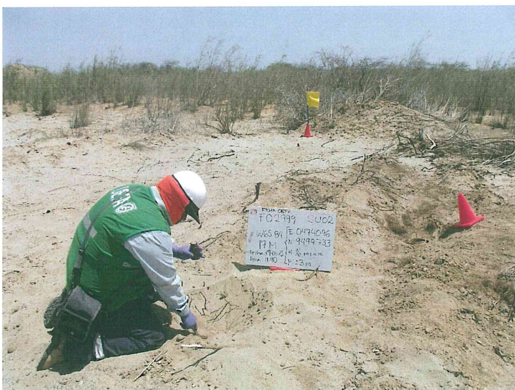
Fotografía N° 4. Toma de muestra de suelo en el punto F02999-SU02, ubicado a 2,4 m aproximadamente del Pozo T3225.
