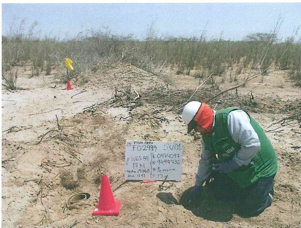
Fotografía N° 3. Toma de muestra de suelo en el punto F02999-SU01, ubicado a 1,3 m de distancia aproximadamente del Pozo T3225.
