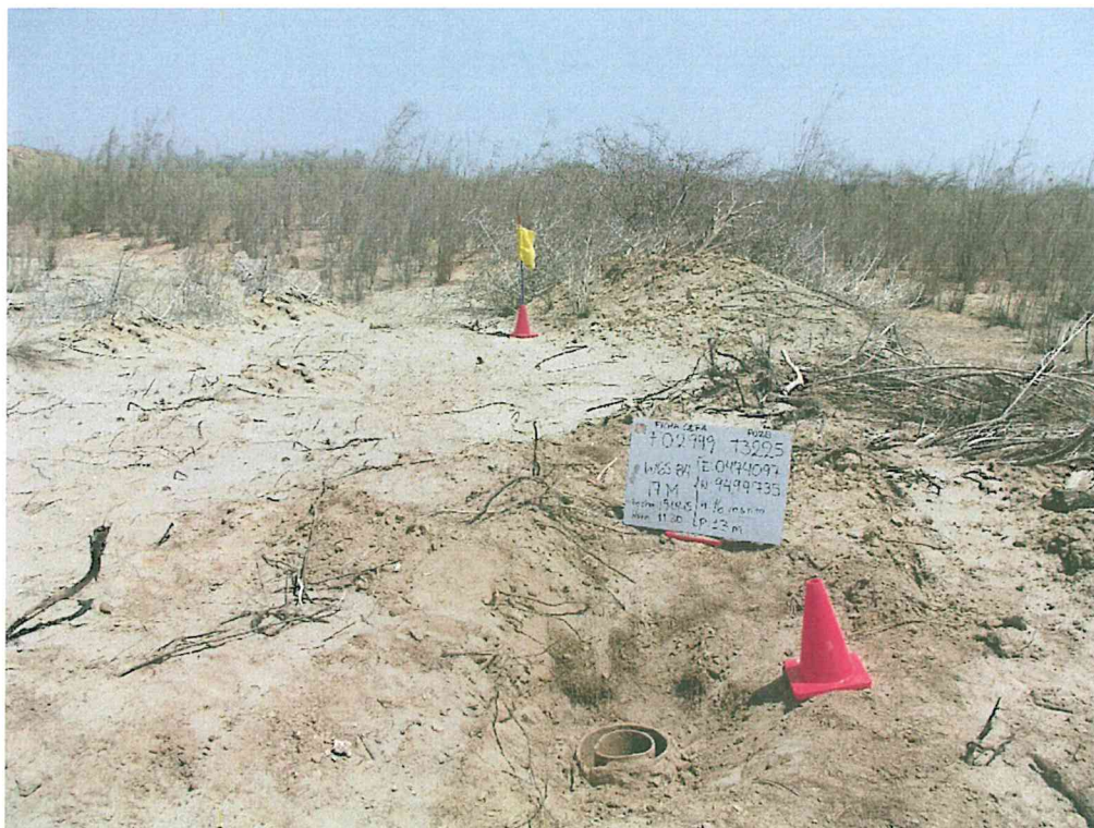
Fotografía N° 1. Ubicación del pozo inactivo, con casing de superficie y un casing intermedio, de 14 pulgadas y 8 pulgadas de diámetro respectivamente, los cuales se encuentran cortados a nivel del suelo. ambos se encuentran corroídos.
