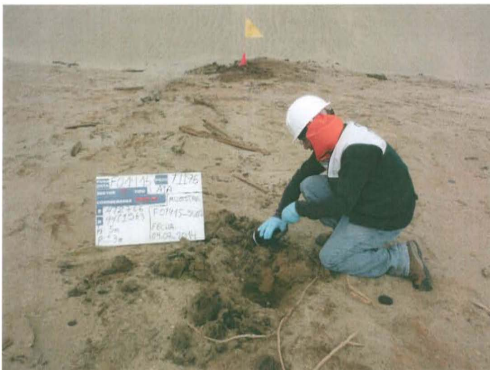
Fotografía N° 4. Toma de muestra de suelo en el punto F01415-SU02, ubicado a 9 m de donde se ubicaría el Pozo T1196.
