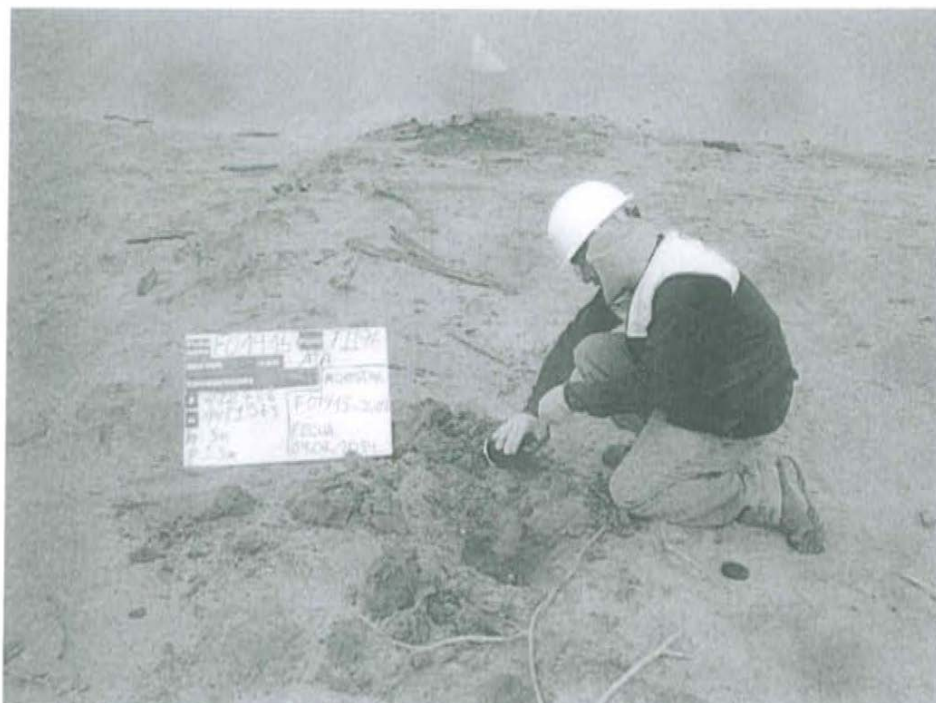
Fotografía N° 2. Toma de muestra de suelo en el punto F01415-SU02, ubicado a 9 m de donde se presume se encuentra el pozo T1196.
