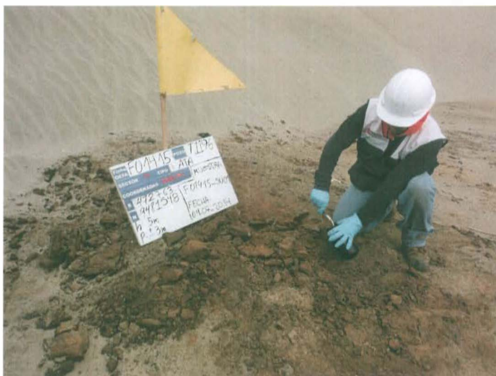
Fotografía N° 3. Toma de muestra de suelo en el punto F01415-SU01, ubicado en el área donde posiblemente se encontraría el Pozo T1196.
