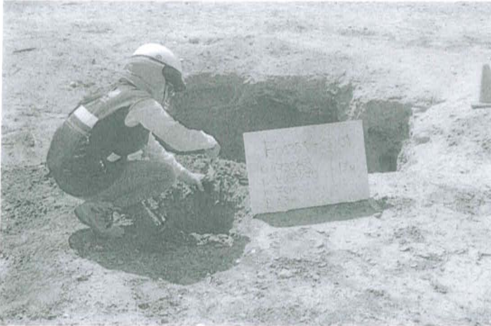
Fotografía N° 1. Toma de muestra en el punto F01351-SU01, ubicado a 2,1 m de distancia del casing del pozo T 2298 a una profundidad de 0,3 m de la superficie del suelo.
