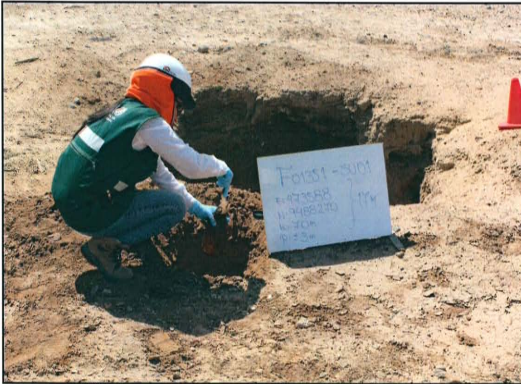
Fotografía N° 3. Toma de muestra en el punto F01351-SU01, ubicado a 2,1 m de distancia del casing del pozo T 2298.
