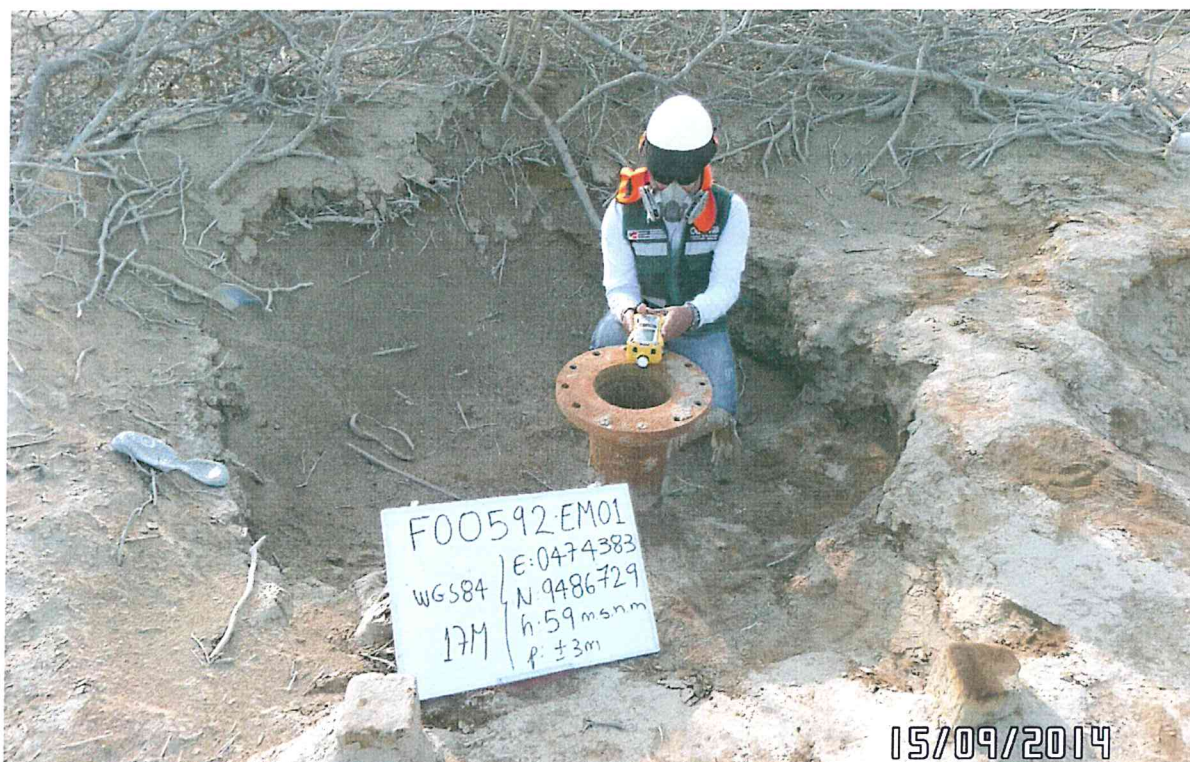
Fotografía N° 6.- Medición en el punto F00592-EM01, ubicado en la fuente de emisión en boca del Pozo T2861.
