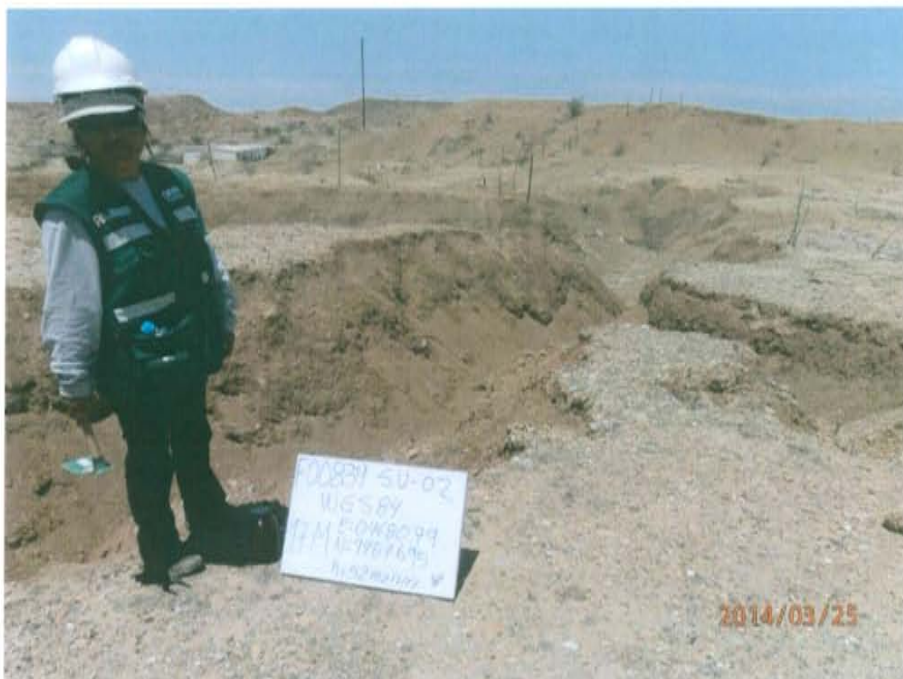
Fotografía N° 4. Toma de muestra de suelo en el punto F00839-SU02 a 20,2 m del pozo y a una profundidad de 0,30 m.
