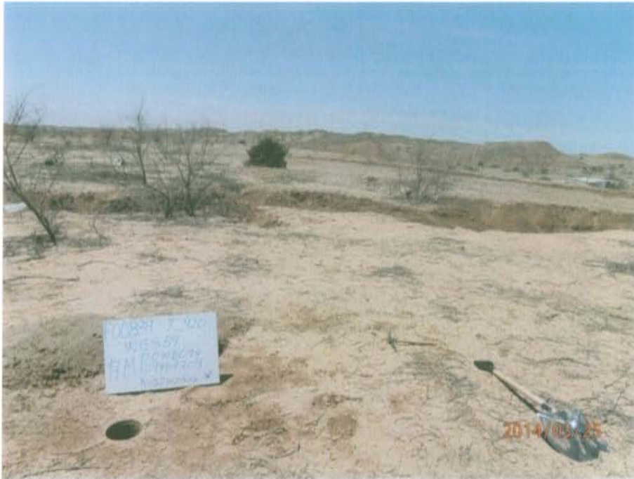
Fotografía N° 1. Pozo inactivo mal abandonado, casing abierto al ras de la superficie del suelo.
