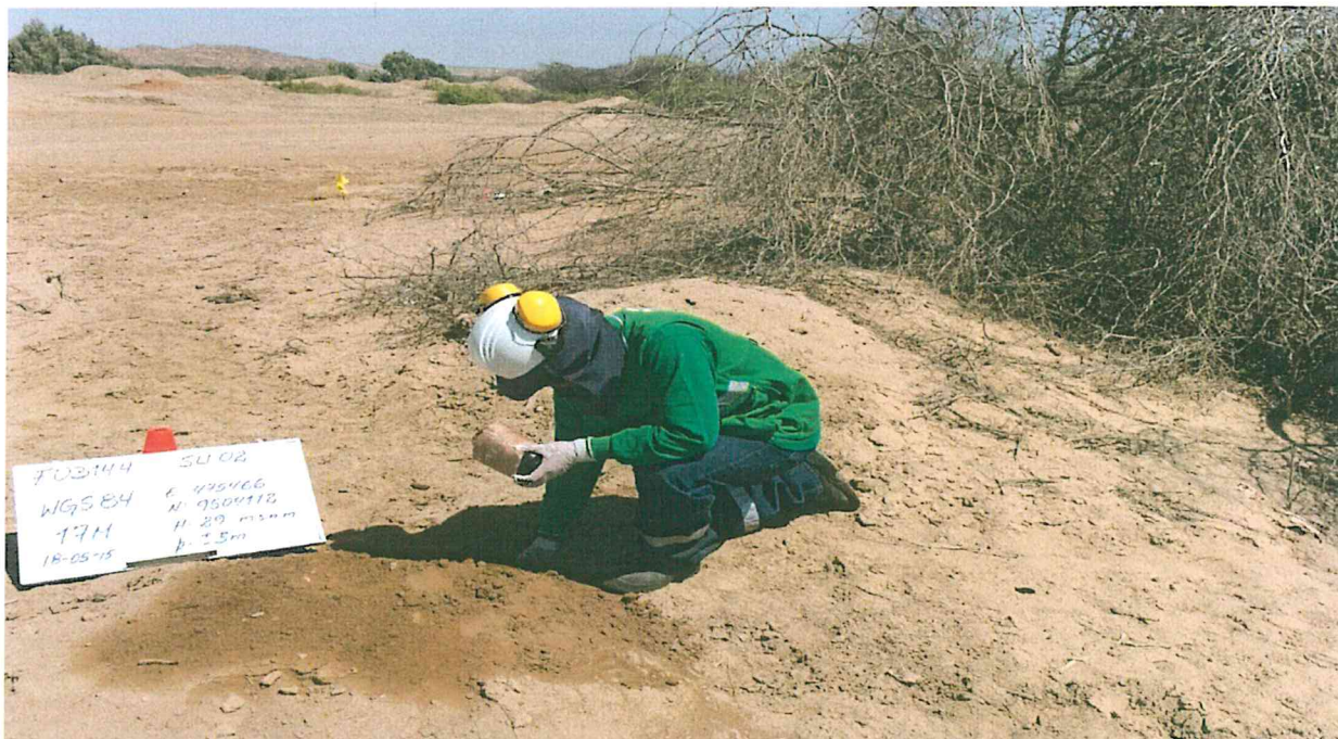
Fotografía N° 4. Toma de muestra en el punto F03144-SU02, ubicado a 14 m al suroeste y a una profundidad de 0,4m
