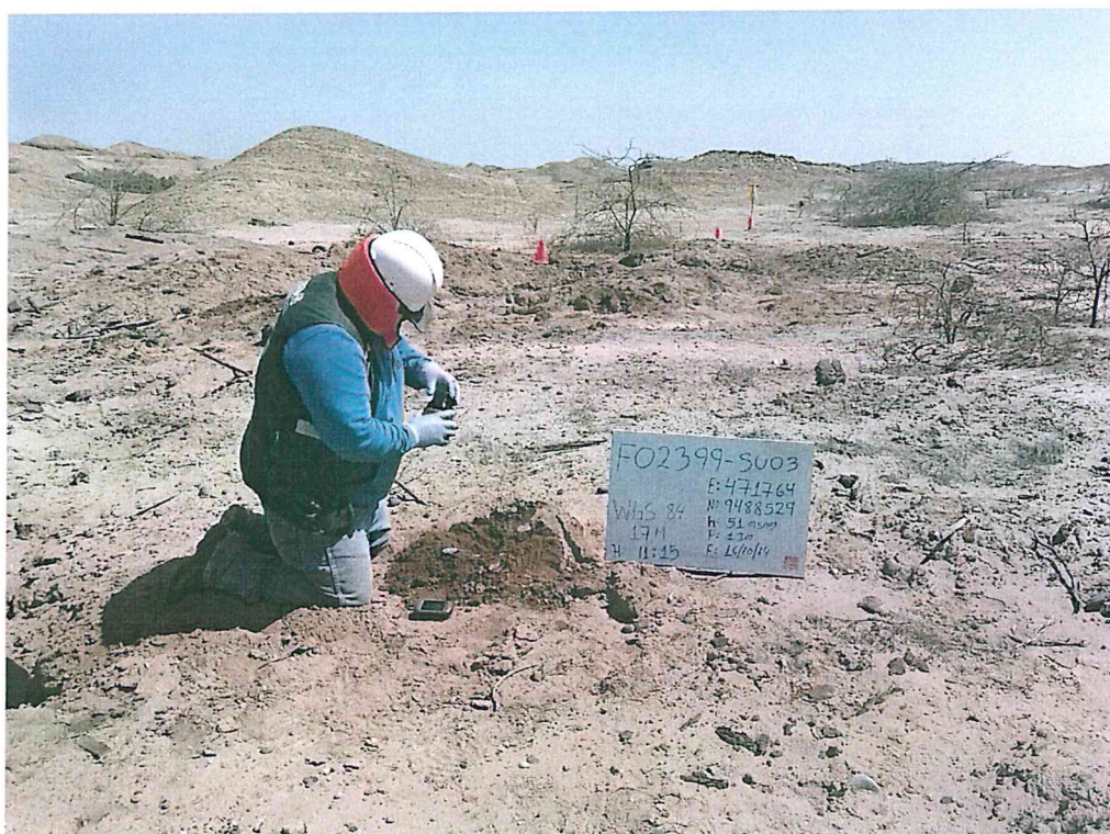
Fotografía N° 4. Toma de muestra de suelo en el punto F02399-SU03, ubicado aproximadamente a 9 m al sur de la posible ubicación del Pozo T_951.
