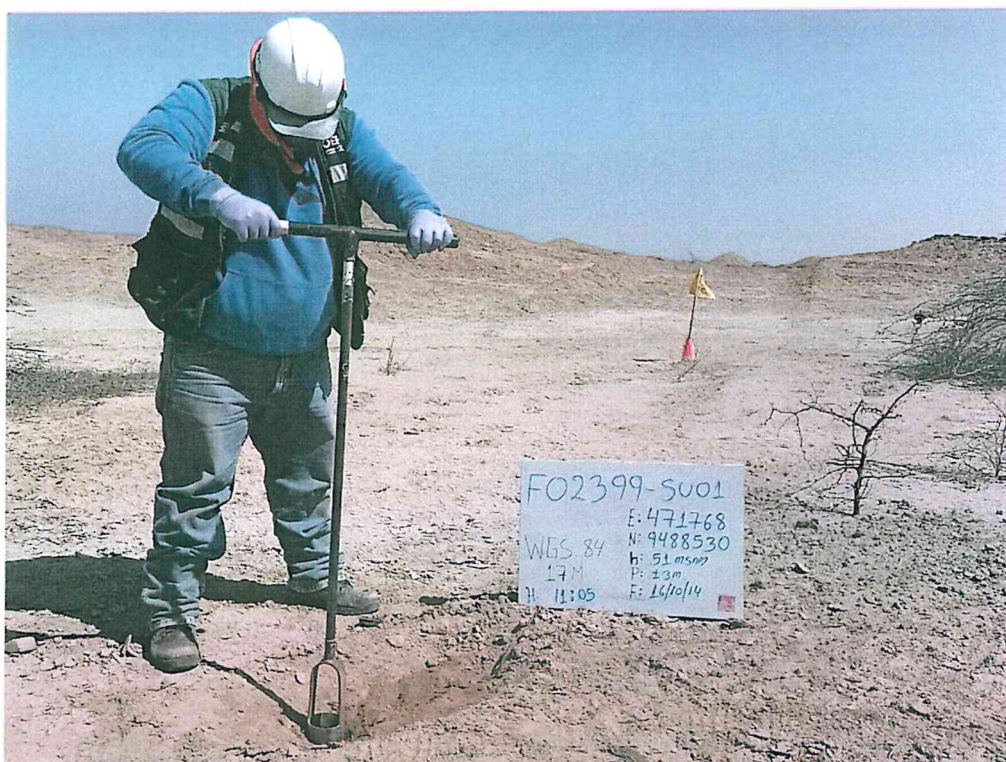
Fotografía N° 3. Toma de muestra de suelo en el punto F02399-SU01, ubicado aproximadamente a 7 m al norte de la posible ubicación del Pozo T_951.
