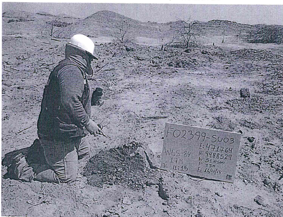
Fotografía N° 3. Toma de muestra de suelo en el punto F02399-SU03, ubicado a 9 m de distancia, al sur de la posible ubicación del Pozo T_951.
