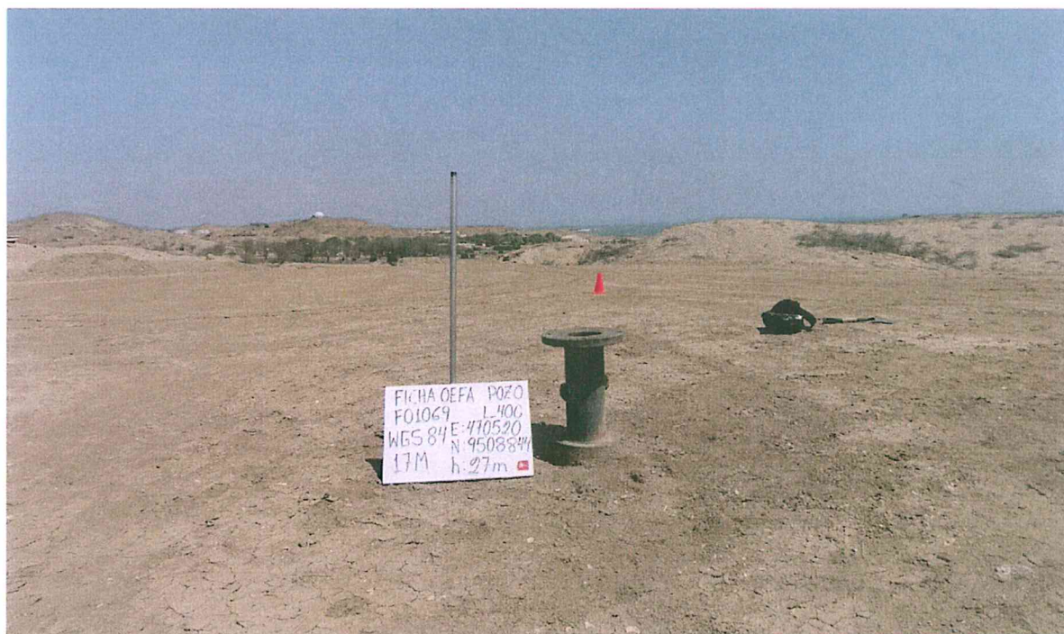
Fotografía N° 2. Pozo L_400, Ficha: F01069, ubicado en terraplén con acceso vehicular, suelo con presencia de hidrocarburo.
