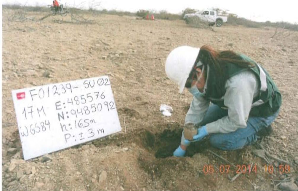
Fotografía N° 4. Toma de muestra de suelo en el punto F01239-SU02, ubicado a 10,3 m aproximadamente del Pozo T2511.
