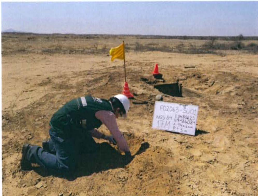
Fotografía N° 3. Toma de muestra de suelo en el punto F02063-SU01, ubicado al Noroeste del pozo y a 3,1 m aproximadamente del Pozo T2647.
