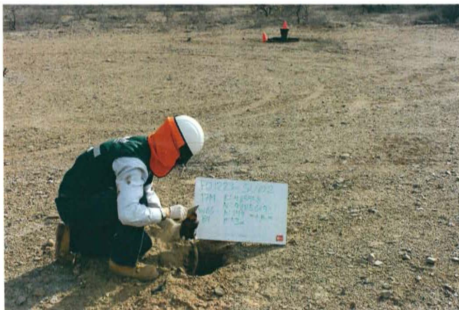
Fotografía N° 4. Toma de muestras de suelo en el punto F01223-SU02, a 17 m del pozo, suelo con coloración más clara y un anclaje de acero.
