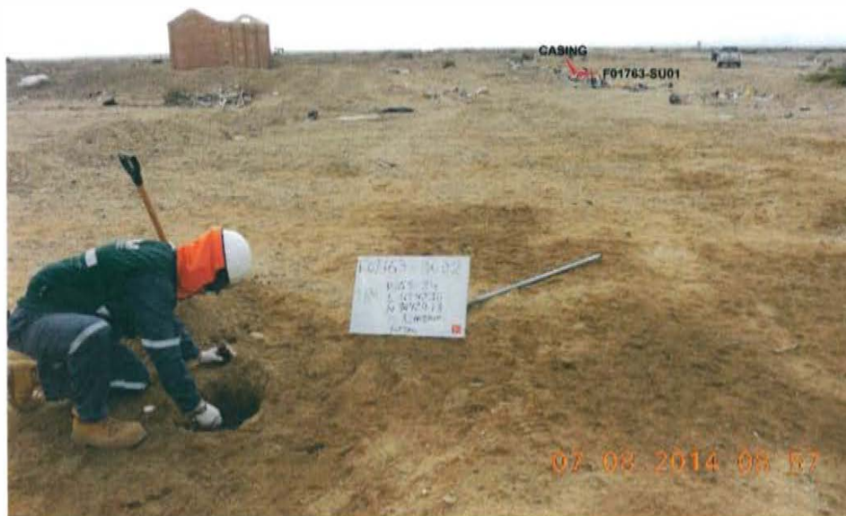
Fotografía N° 4. Toma de muestra de suelo en el punto F01763-SU02, ubicado a 59 m del cabezal del pozo T2839
