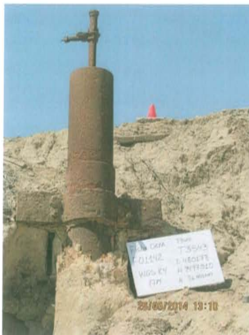
Fotografía N° 1. Pozo inactivo con código PERUPETRO T3543, se encuentra en la pendiente de una colina, pozo con casing y tubing de aproximadamente 1.97 m de alto.
