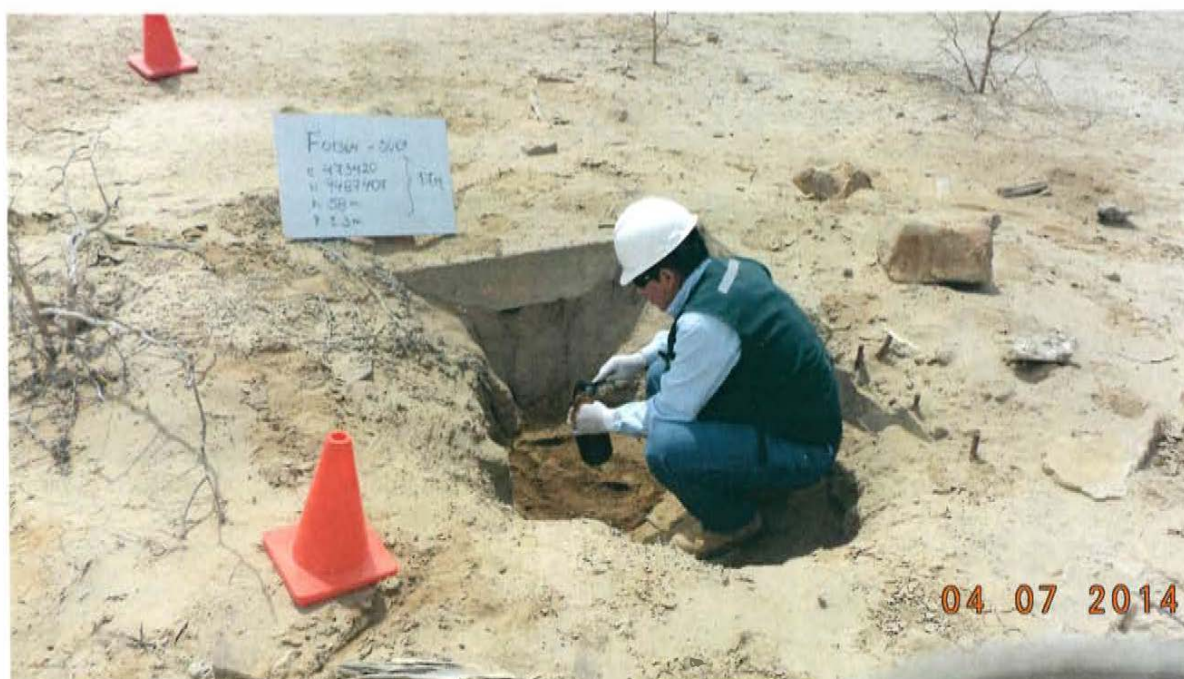
Fotografía N° 3. Toma de muestra de suelo en el punto F01364-SU01, ubicado a 0,25 m aproximadamente del Pozo T5203.
