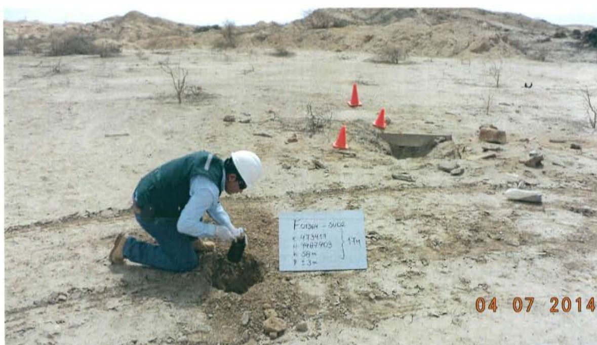
Fotografía N° 4. Toma de muestra de suelo en el punto F01364-SU02, ubicado a 4,3 m aproximadamente del Pozo T5203, donde se observan residuos de concreto y madera.
