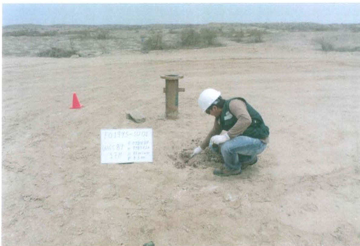
Fotografía N° 3. Toma de muestra de suelo en el punto F01945-SU01, ubicado a 2,5 m aproximadamente del Pozo T2367.
