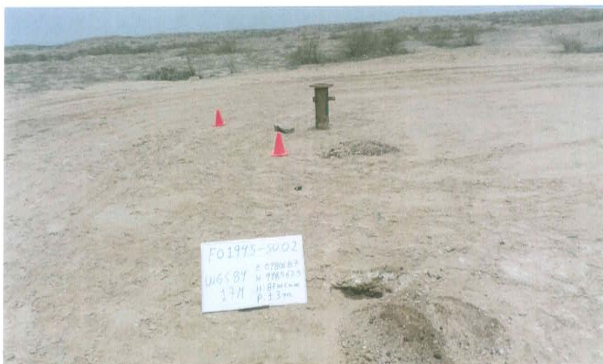
Fotografía N° 4. Toma de muestra de suelo en el punto F01945-SU02, ubicado a 5,5 m aproximadamente del Pozo T2367.
