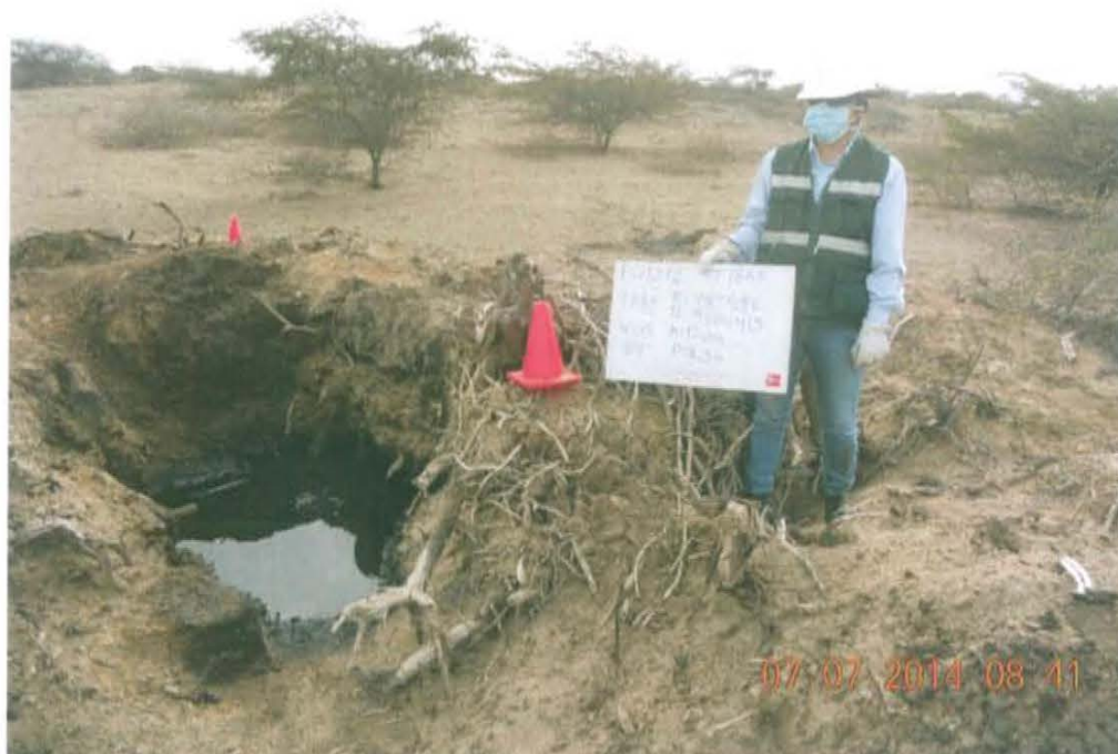
Fotografía N° 1. Se observa pozo inactivo expuesto al ambiente, en el interior de una cantina deteriorada.
