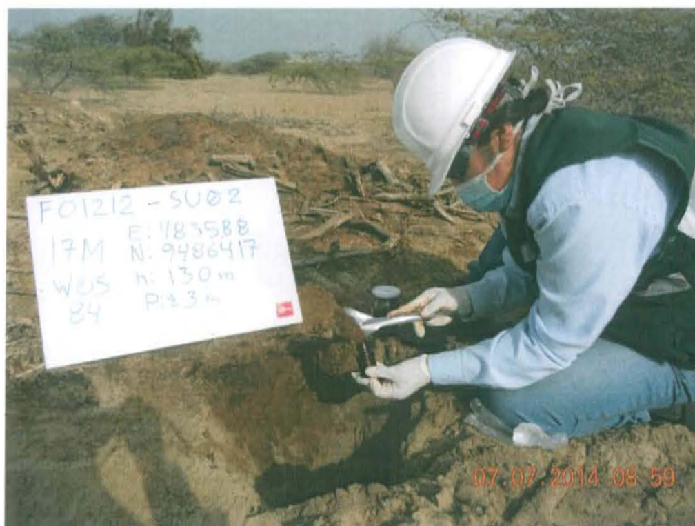
Fotografía N° 4. Toma de muestra de suelo en el punto F01212-SU02, ubicado a 4,6 m aproximadamente de la posible ubicación del pozo T1863.
