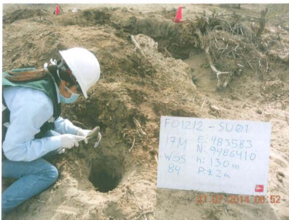
Fotografía N° 3. Toma de muestra de suelo en el punto F01212-SU01, ubicado a 2,6 m aproximadamente de la posible ubicación del pozo T1863.
