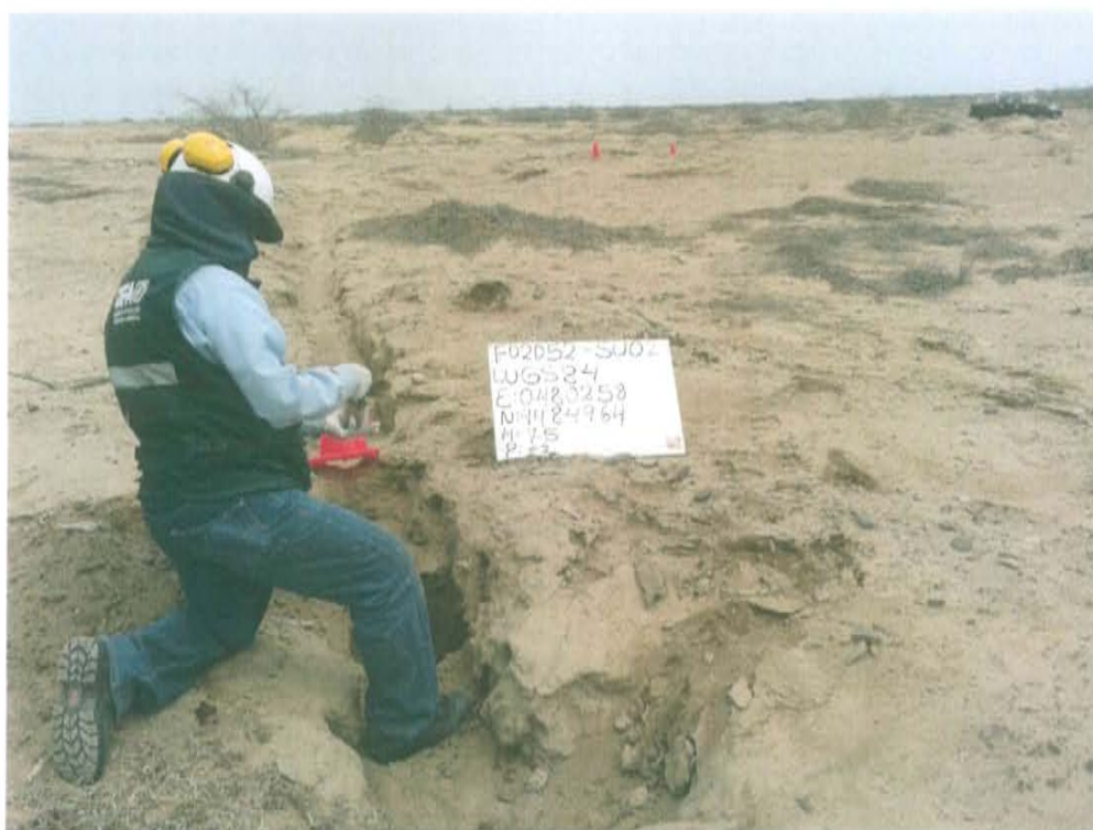
Fotografía N° 4. Toma de muestra de suelo en el punto F02052-SU02, ubicado a 13 m aproximadamente del Pozo T2874.
