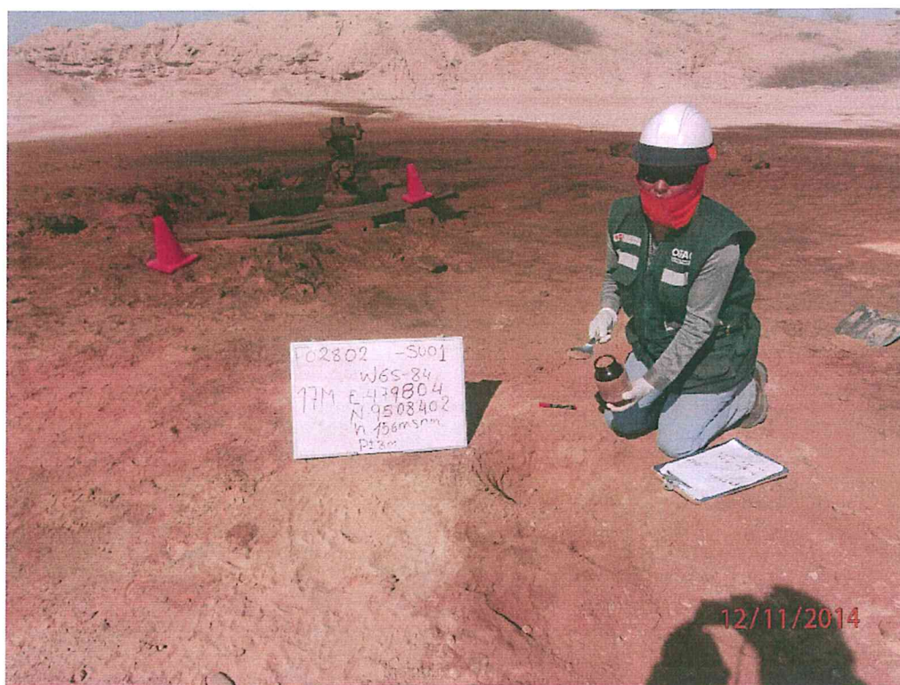
Fotografía N° 3. Toma de muestra de suelo en el punto F02802-SU01, ubicado a 3 m aproximadamente del Pozo L1565.
