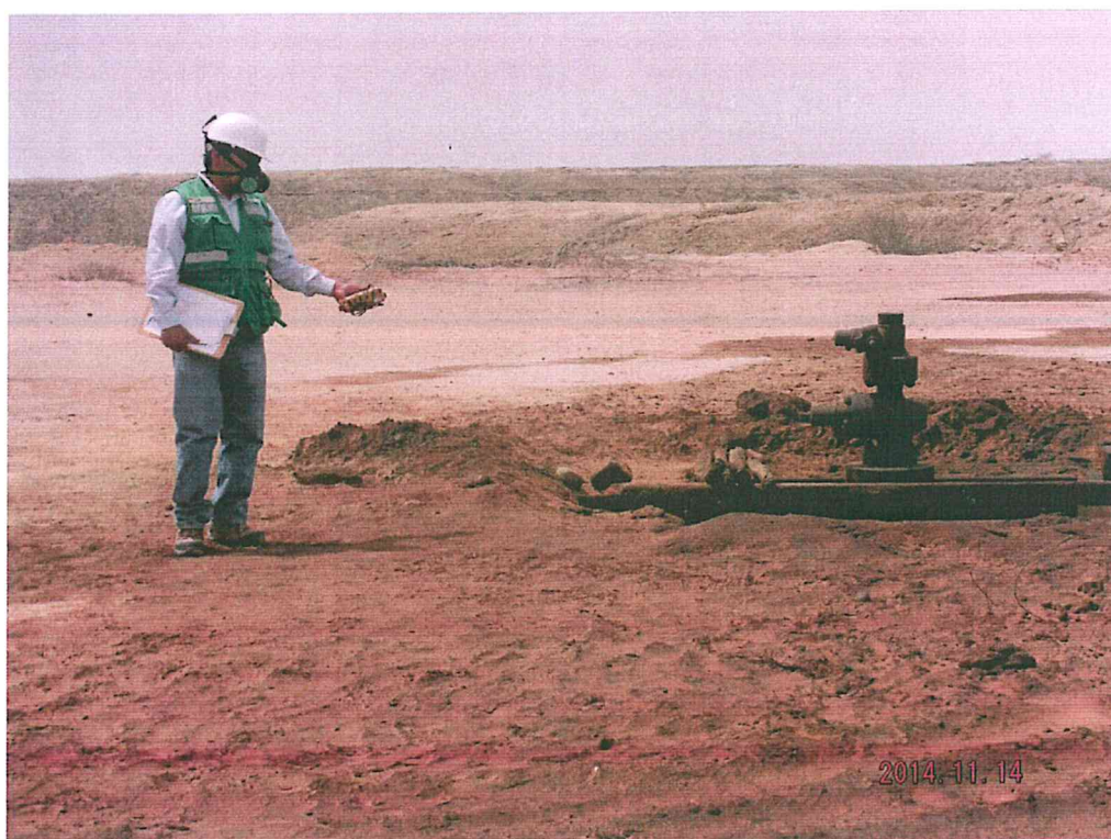
Fotografía N° 6. Mediciones en el F02802-VA01, se realizó en un radio de 1 m, con una duración de 10 minutos.
