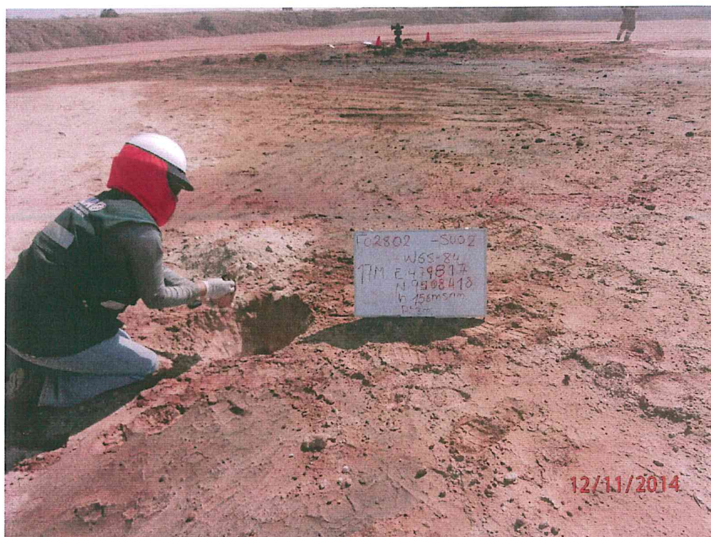
Fotografía N° 4. Toma de muestra de suelo en el punto F02802-SU02, ubicado a 13 m aproximadamente del Pozo L1565.
