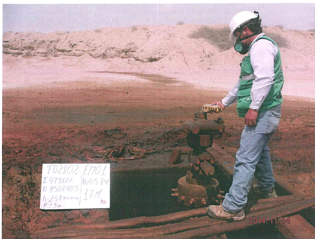
Fotografía N° 5. Medición en el punto F02802-EM01, ubicado en la fuente de emisión en boca del Pozo L1565.
