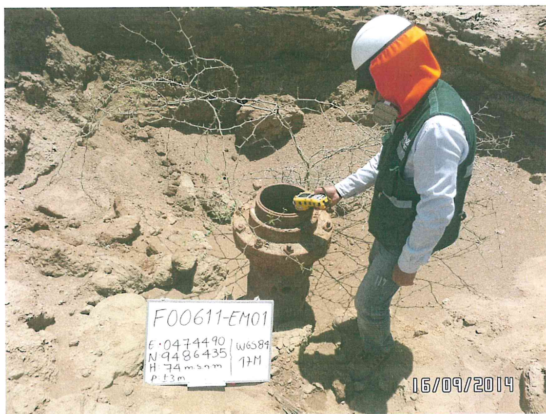
Fotografía N° 3. Medición de emisiones gaseosas fugitivas en el punto F00611-EM01, ubicado en la fuente de emisión en boca del Pozo T2669.
