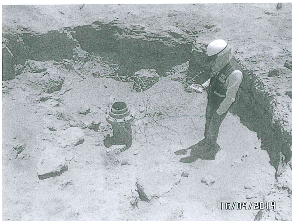
Fotografía N° 2. Mediciones en el F00611-VA01, se realizó en un recorrido en el área circundante alrededor del Pozo en un radio de 1 m, con una duración de 10 minutos.
