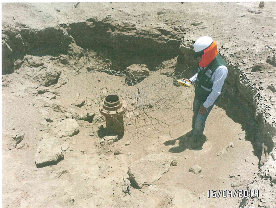
Fotografía N° 4. Mediciones de emisiones gaseosas fugitivas en el F00611-VA01, se realizó en un recorrido en el área circundante alrededor del Pozo en un radio de 1 m, con una duración de 10 minutos.
