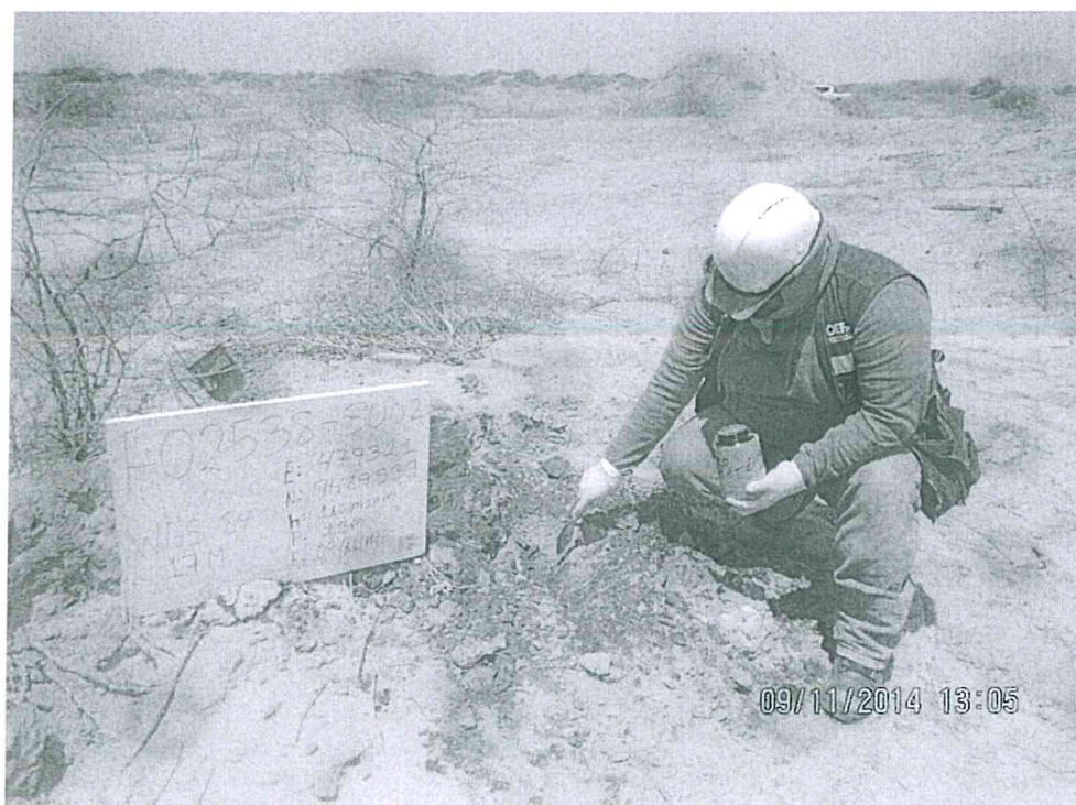
Fotografía N° 2. Toma de muestra de suelo en el punto F02538-SU02, ubicado a 17 m aproximadamente al oeste del pozo T2215
