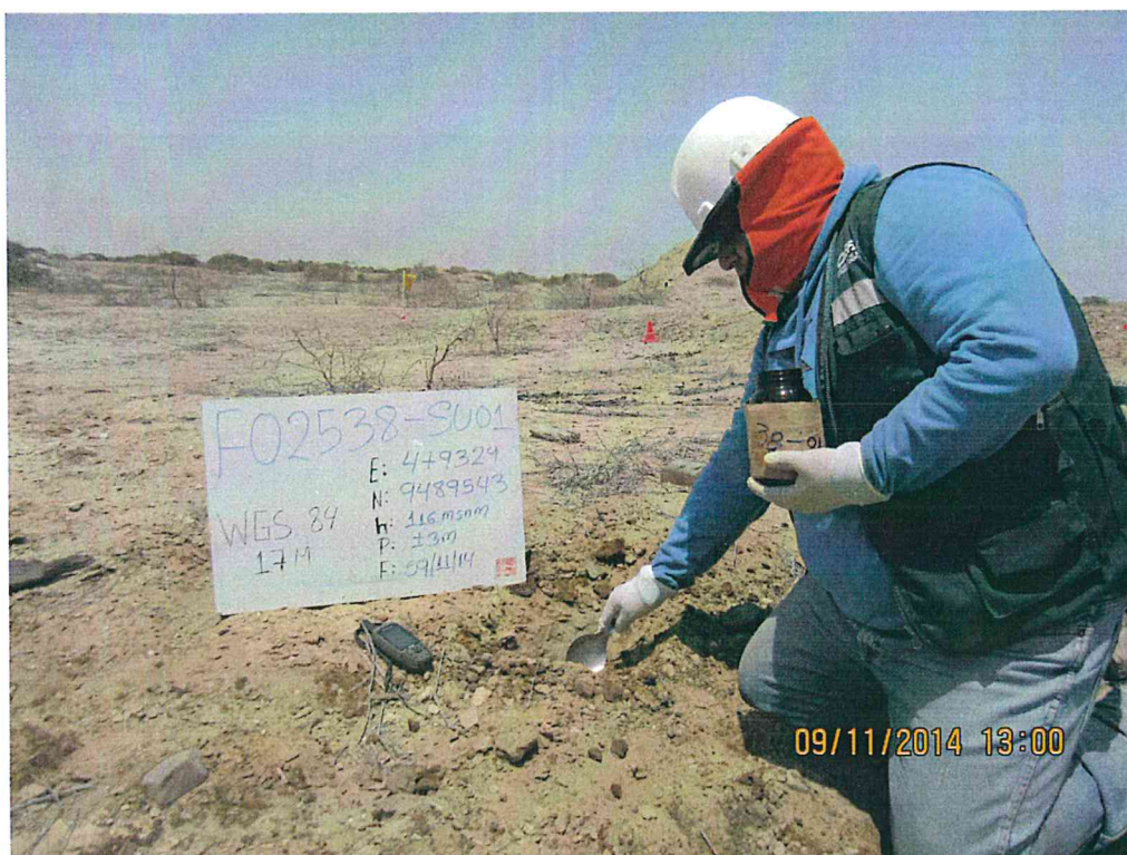
Fotografía N° 3. Toma de muestra de suelo en el punto F02538-SU01, ubicado a 6,8 m aproximadamente al oeste del pozo T2215
