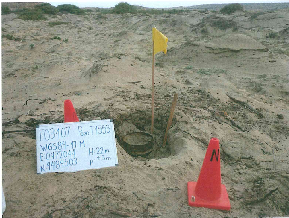
Fotografía N° 1. Vista pozo T1553, se observa el casing al interior de un hoyo.
