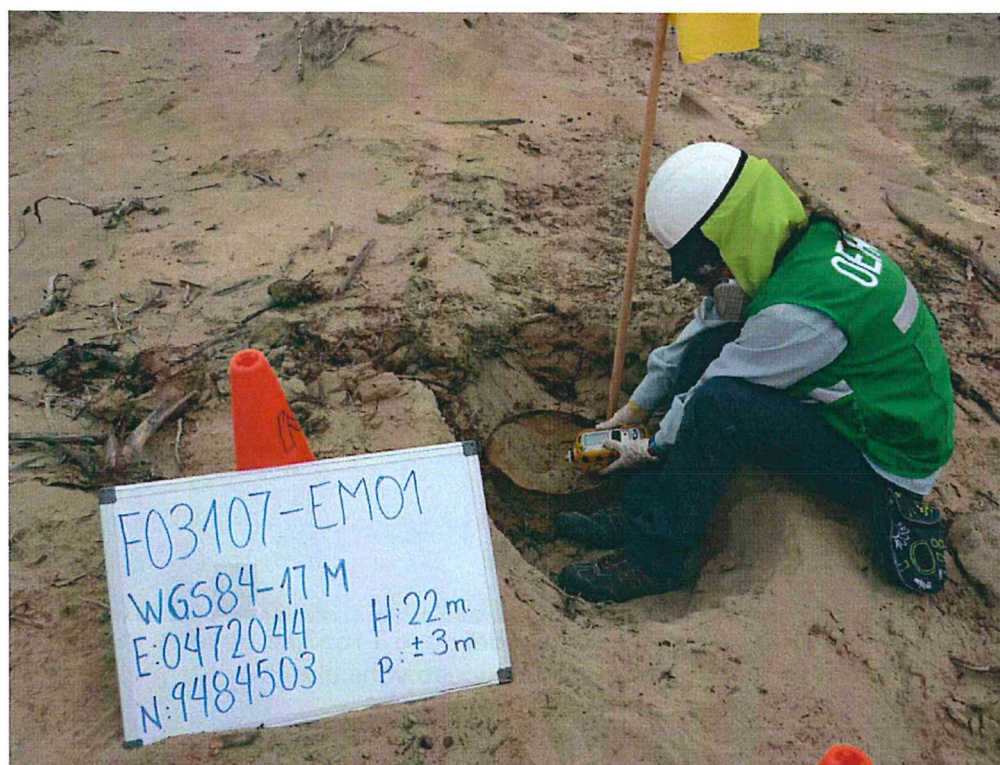
Fotografía N° 4. Vista de la medición de emisiones en el punto F03107-EM01, ubicado en boca del Pozo T1553.
