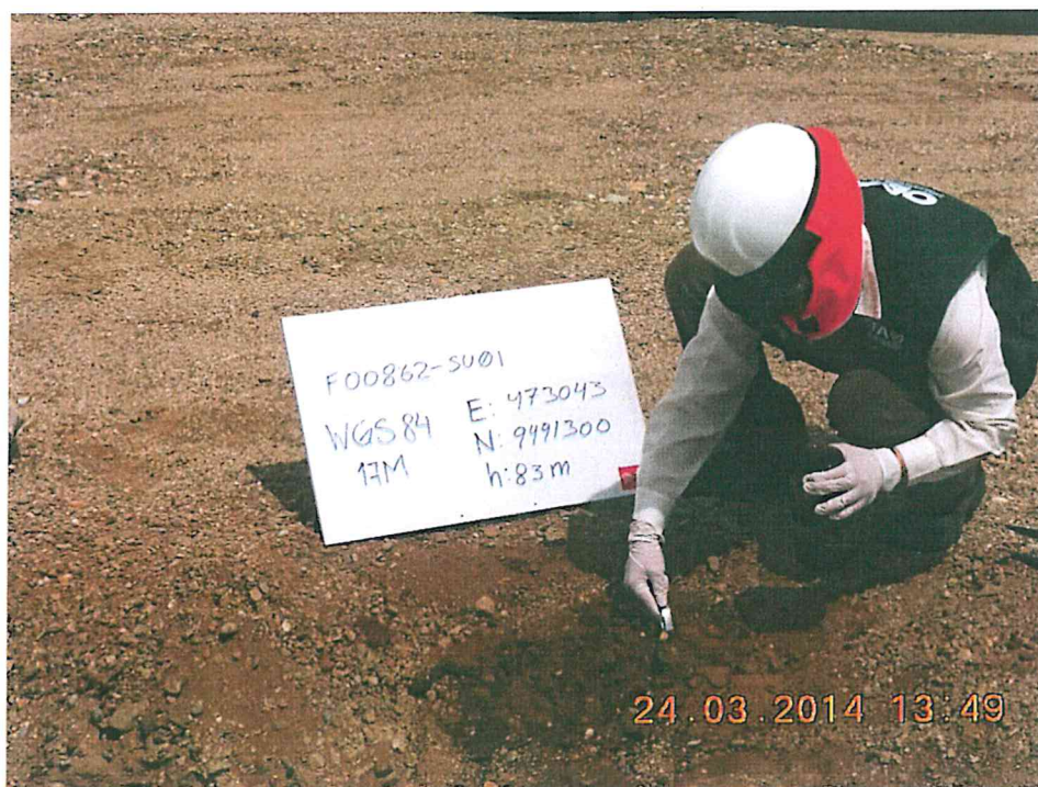
Fotografía N° 3. Toma de muestra de suelo en el punto F00862-SU01, ubicado a 1,4-m del casing del pozo T3614.
