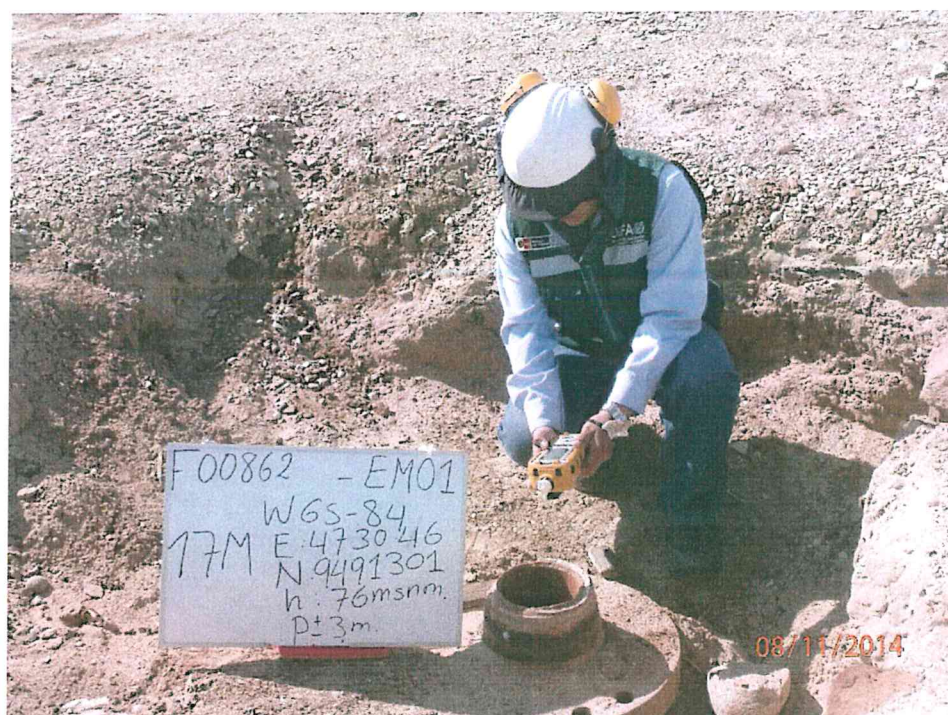
Fotografía N° 4. Medición de emisiones gaseosas fugitivas en el punto F00862-EM01.
