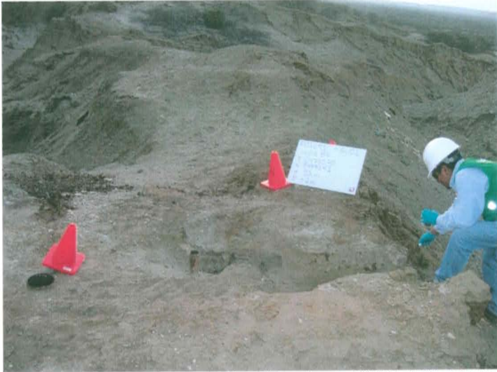
Fotografía N° 3. Toma de muestra de suelo en el punto F01691-SU01 ubicado a 3,6 m al noreste del Pozo T3271.
