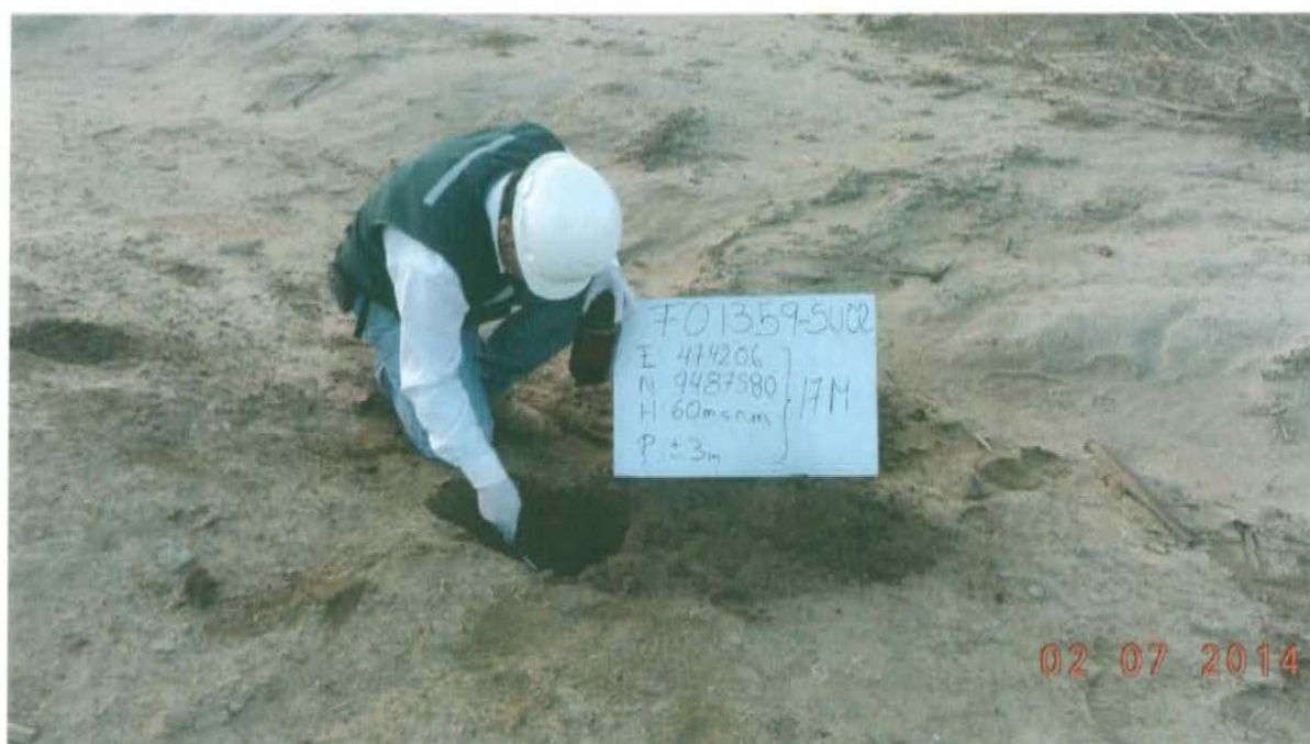
Fotografía N° 4. Toma de muestra de suelo en el punto F01359-SU02, ubicado a 2,5 m aproximadamente del Pozo T2781.
