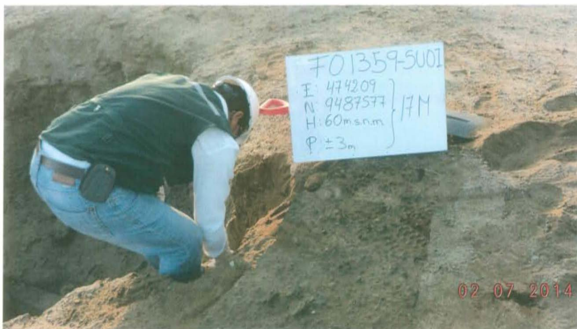
Fotografía N° 3. Toma de muestra de suelo en el punto F01359-SU01, ubicado a 0,4 m aproximadamente del Pozo T2781.
