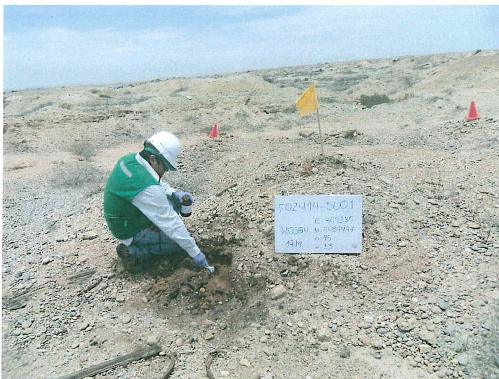
Fotografía N° 3. Toma de muestra de suelo en el punto F02414-SU01, ubicado a 3,1 m de la posible ubicación del casing del pozo.
