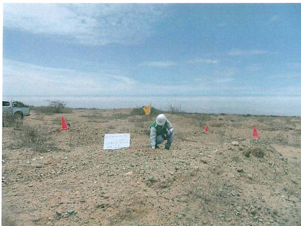
Fotografía N° 4. Toma de muestra de suelo en el punto F02414-SU02 ubicado a 3,8 m de la posible ubicación del casing del pozo.
